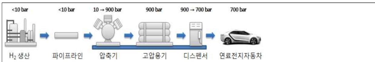
[그림 89] 생산지역에서 수소충전소까지 파이프라인으로 수소를 이송하는 방식
