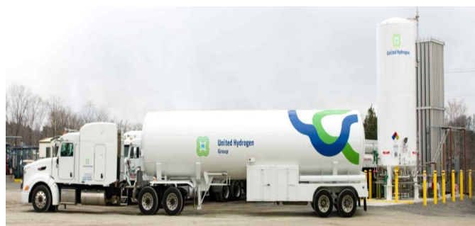
[그림 212] LH 2 수송용 트레일러: 실린더 방식으로 수송 효율이 낮음
