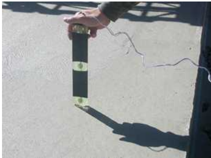
〈양생 온도 모니터링을 통한 실시간 콘크리트 품질관리 기술 (i-Button 적용 사례)〉
