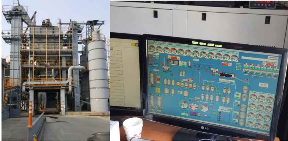
〈S사 포장 생산 플랜트 및 스카다 시스템 예〉
