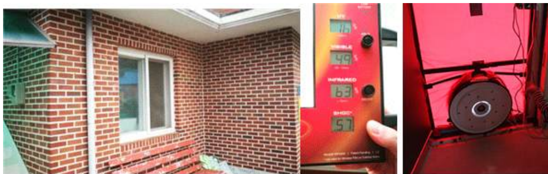
그림 177. 현장 창호 성능 측정 및 기밀테스트 모습
