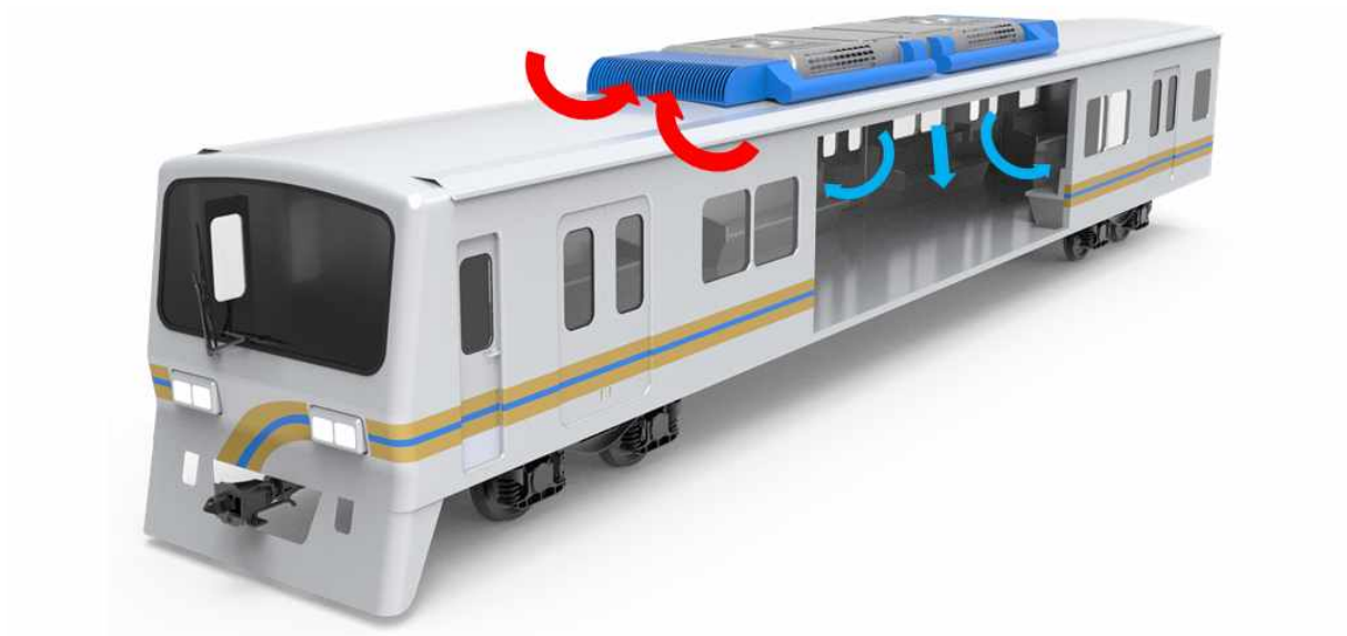
<그림 3-4> (초)미세먼지 고속, 고용량 집진 제거기술의 개념도
