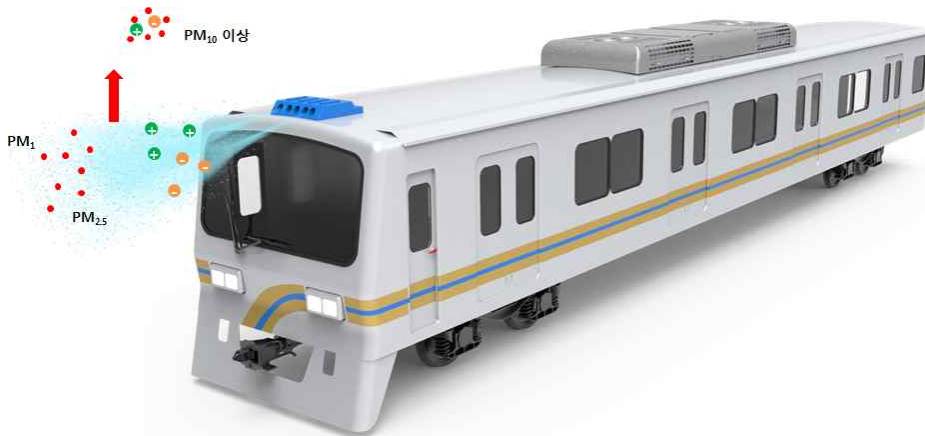
<그림 3-11> 저에너지 소모형 (초)미세먼지 제거기술의 개념도
