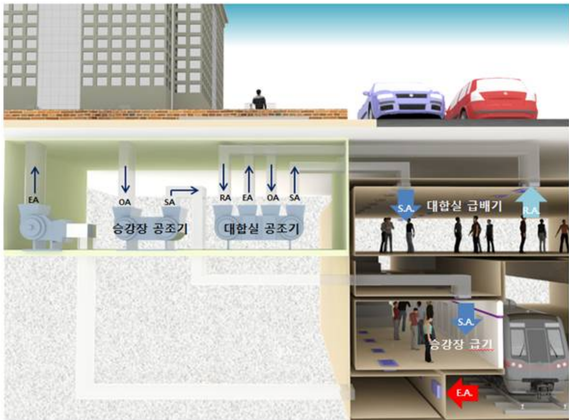
<그림 1-8> 지하철 역사의 공조시스템
