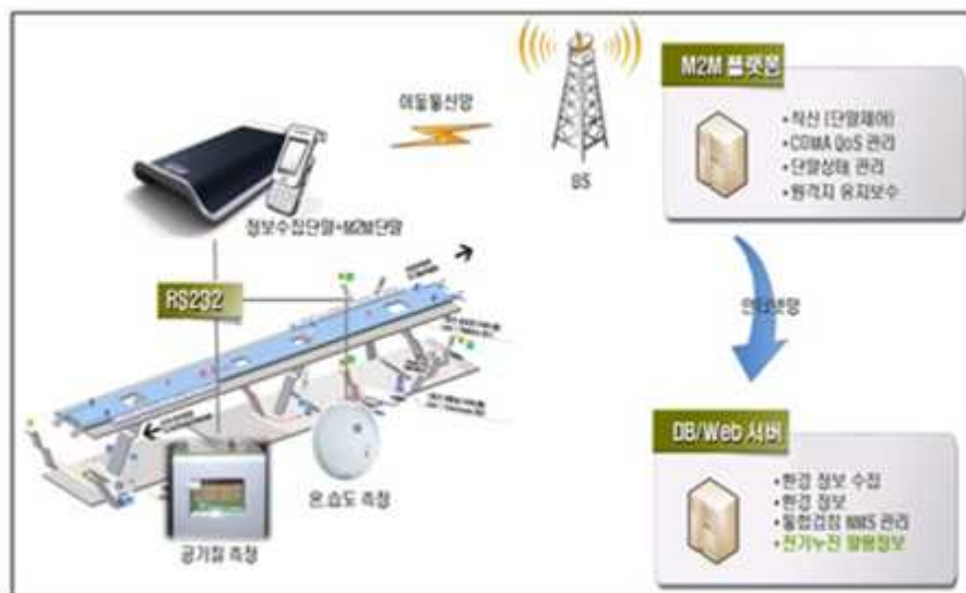
<그림 2-12> M2M CDMA 무선통신을 이용한 실내환경 모니터링 시스템
