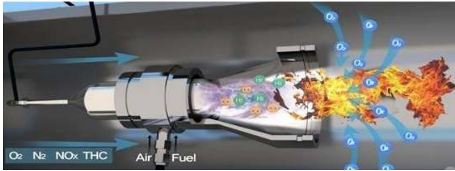
<그림 2-71> 한국기계연구원 연구팀이 개발한 미세먼지 플라즈마 버너 작동원리
