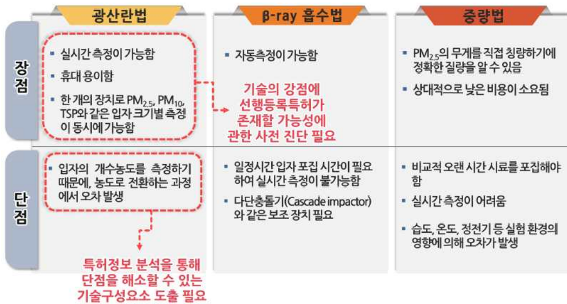
<그림 2-11> 입자상 오염물질의 측정 방법
