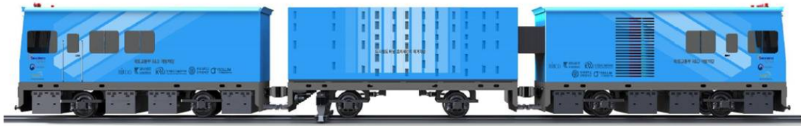
〈그림 2-52〉 개발 중인 (초)미세먼지 제거차량 개념도
