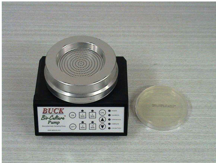
<그림 2-34> 공기 중 총 부유세균 포집장치
