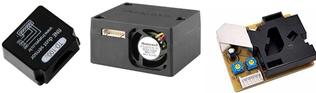
<그림 2-51> 소형 미세먼지 측정 센서 (Trueeyes, Honeywell, Shinyei Technology)
