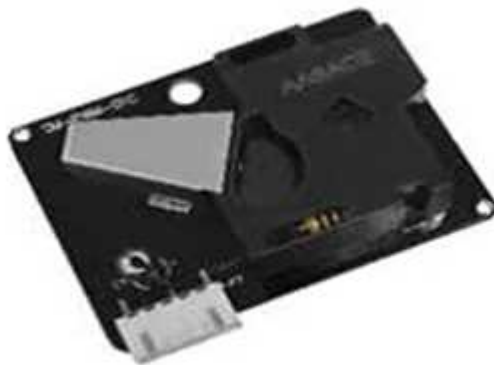
<그림 2-67> Hitachi에서 개발한 실내 공기오염도 모니터링 센서
