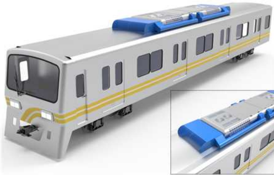
<그림 3-9> 전동차 HVAC 부착형 고속 고용량 (초)미세먼지 집진기술의 개념도
