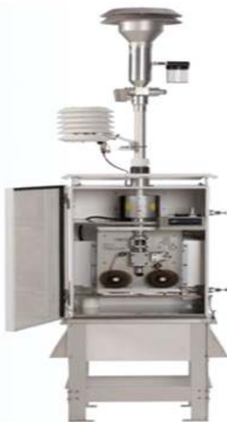
<그림 2-13> 미세먼지 측정을 위한 베타 방사선 측정기술
