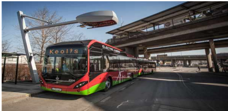
<그림 2-1-77> Siemens社의 자동충전장치
