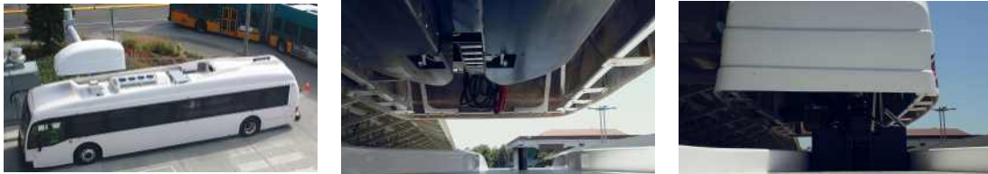
<그림 2-1-73> Proterra社의 전기버스와 충전장치
