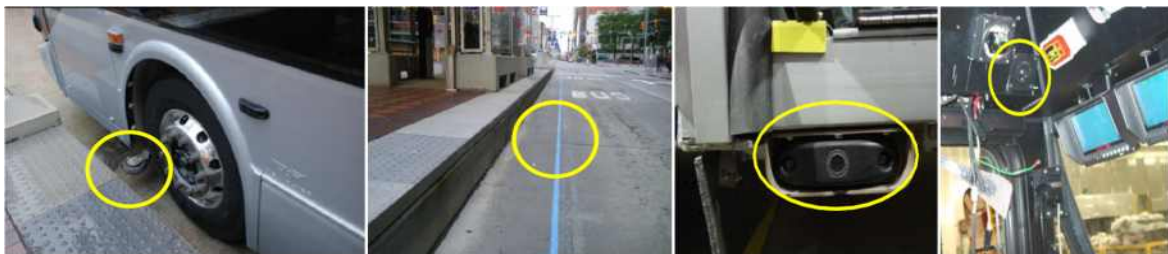
<그림 2-1-50> precision docking 구성요소 (MGW / BGS / DAS)
