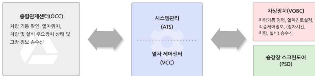
<그림 2-1-45> 열차 무인운전 시스템의 원리
