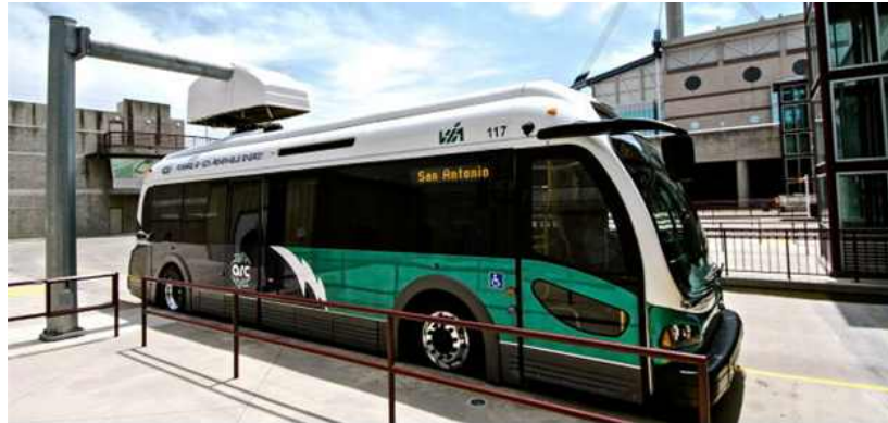
<그림 2-1-73> Proterra社의 전기버스와 충전장치
