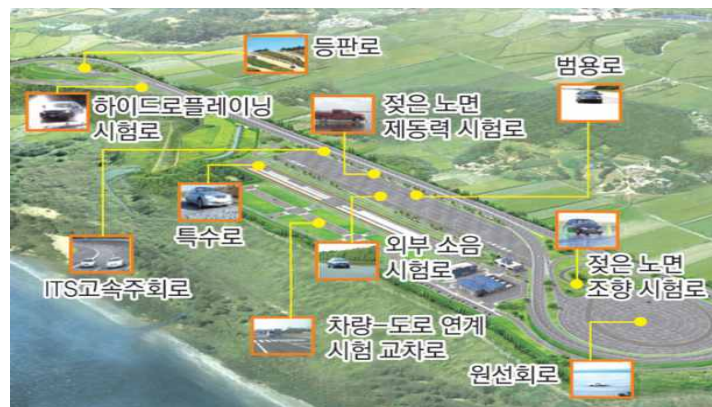
<그림 4-1-1> 지능형 자동차 부품시험장 구조
