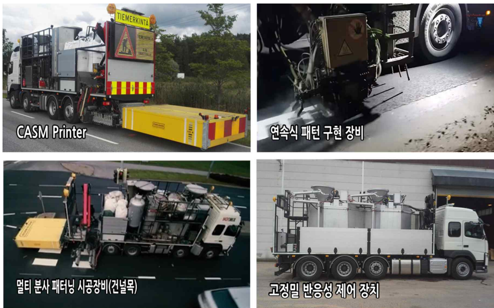
그림 70 연속식 다중 분사 노면표시 시공 장비
