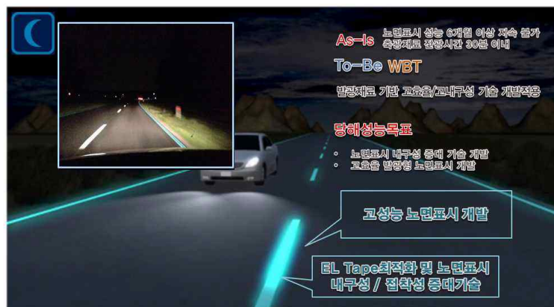
그림 78 고성능 노면표시 및 발광형 노면표시 기술 개념도
