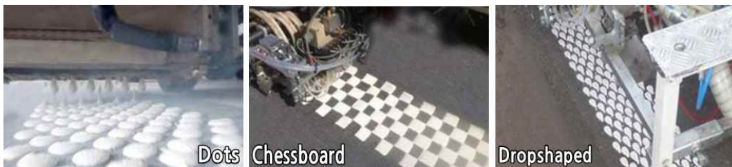
그림 72 도로노면표시 입체 패터닝 시공 장비(BORUM)
