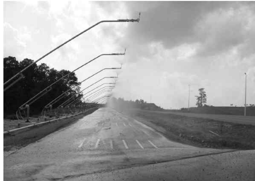
그림 80 Rain Tunnel를 이용한 도로 노면표시 재료 평가방법
