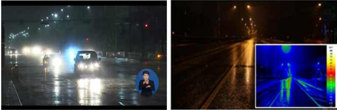
그림 6 야간/우천시 시인성 저하 및 도로조명 의한 차선 난반사 사례
