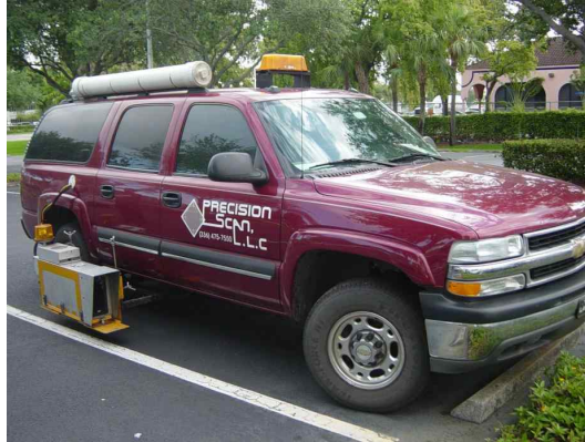
그림 82 도로 노면표시 성능평가를 위한 조사장비
