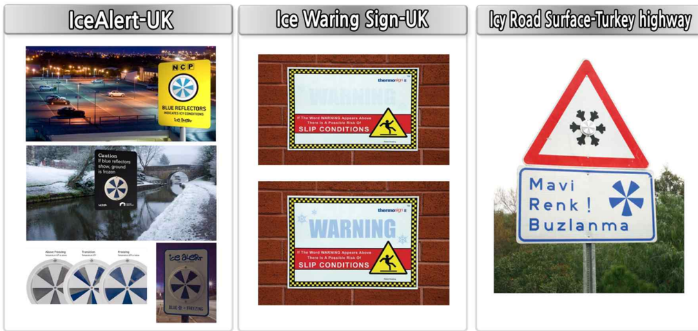
그림 64 온도감응형 소재를 활용한 도로표지 활용 예
