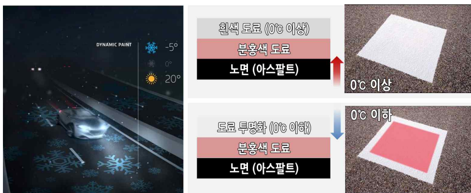
그림 60 열변색 Colorless Paint 적용
