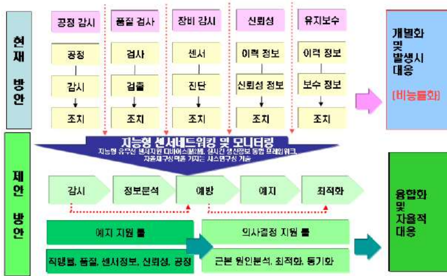
[그림 2.97] IT센서 네트워크 기반 유지보수 결정 프로세스
