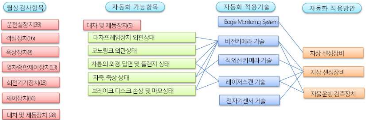
[그림 4.5] 월상검사항목 : 자동화 적용기술 및 적용방안
