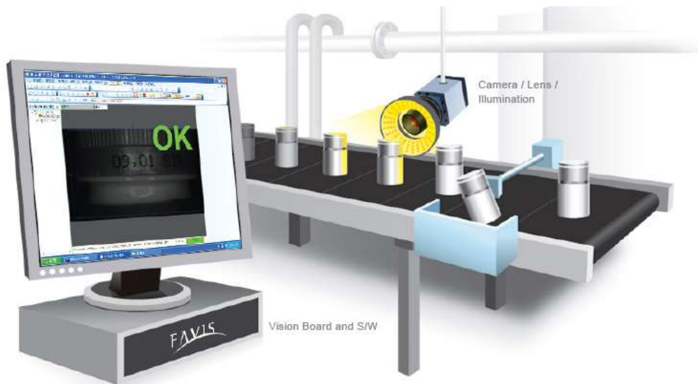
[그림 2.78] 카메라 비전을 이용한 결함검사
