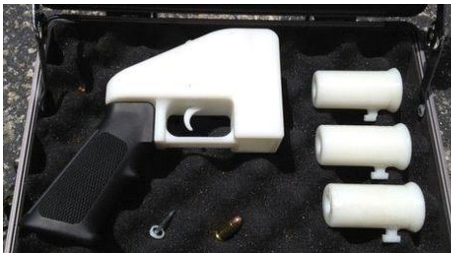
[그림 68] 3D 프린터를 이용하여 제작된 총기
