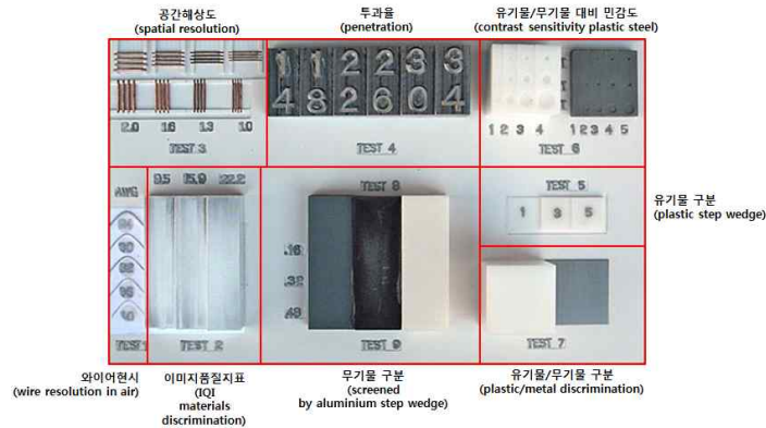
[그림 63] ASTM F792 Test kit
