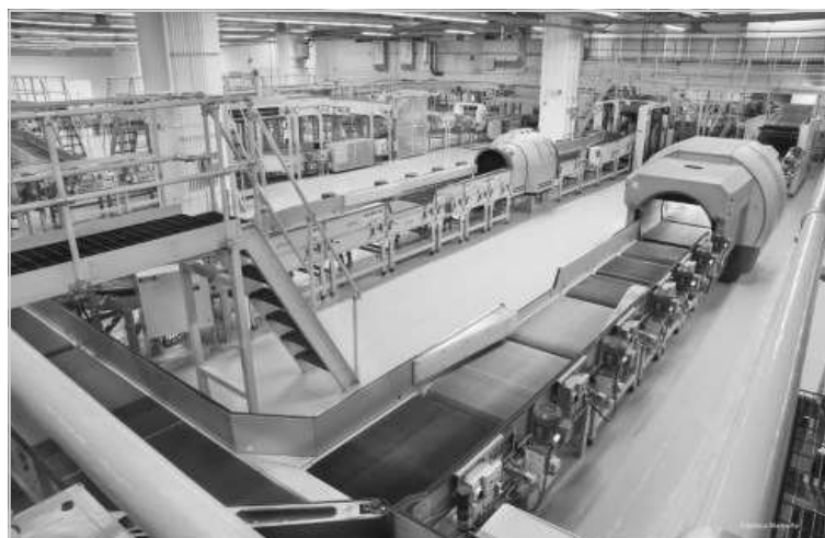
[그림 70] TSIF의 장비 내구성 시험을 위한 컨베이어 시스템
