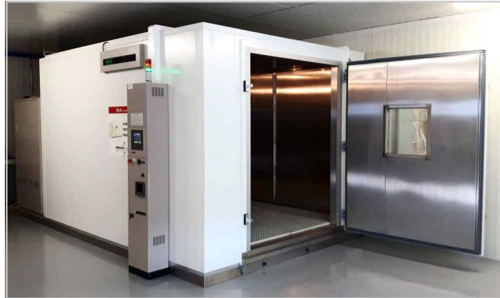
[그림 113] 온습도시험용 대형룸챔버 [예시]
