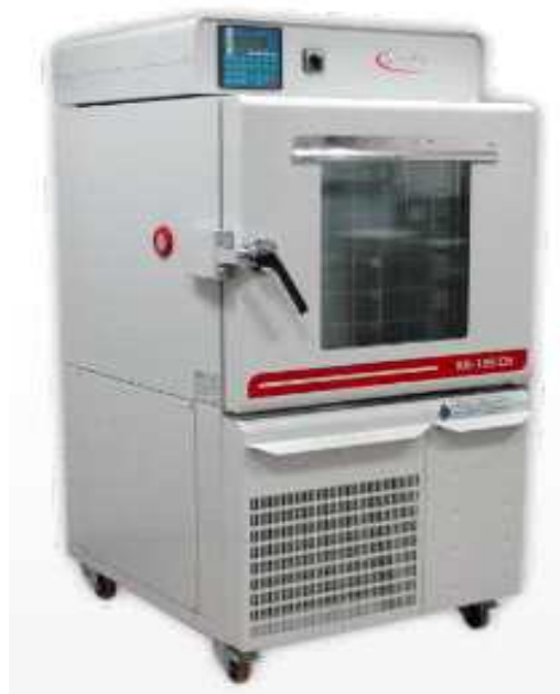
[그림 115] 온습도시험용 소형챔버(예시)
