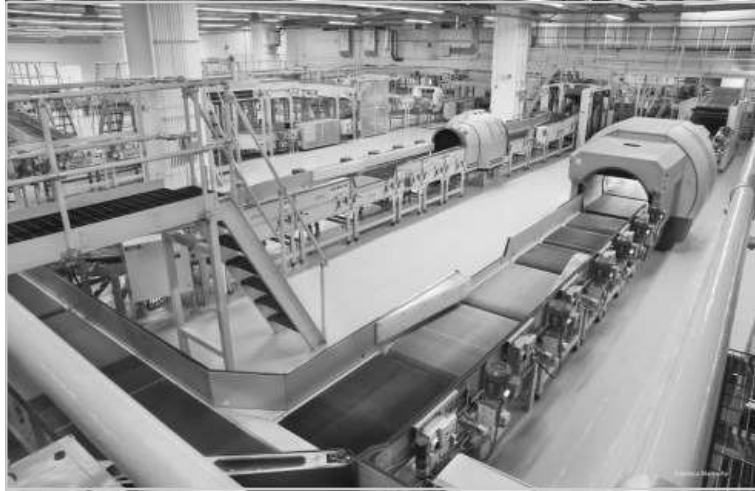
[그림 110] 항공보안장비 내구성시험을 위한 컨베이어 시스템
