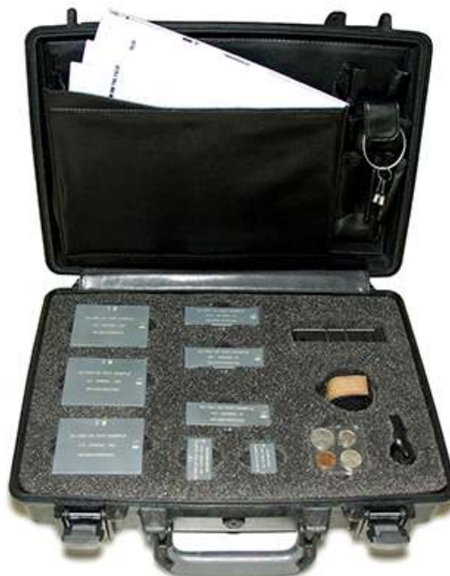
[그림 125] 문형금속탐지장비 감도 시험용 Test Kit 2
