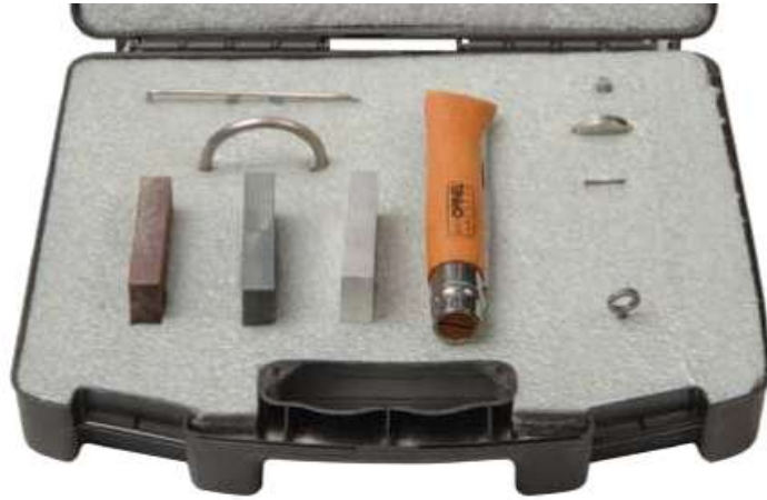
[그림 124] 문형금속탐지장비 감도 시험용 Test Kit
