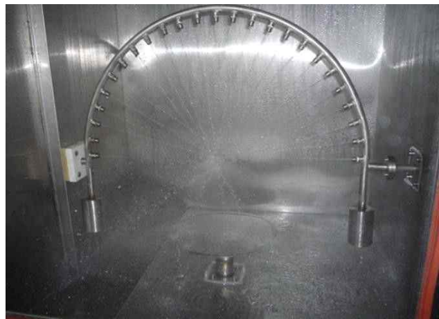
[그림 116] 방수시험용 챔버 [예시]
