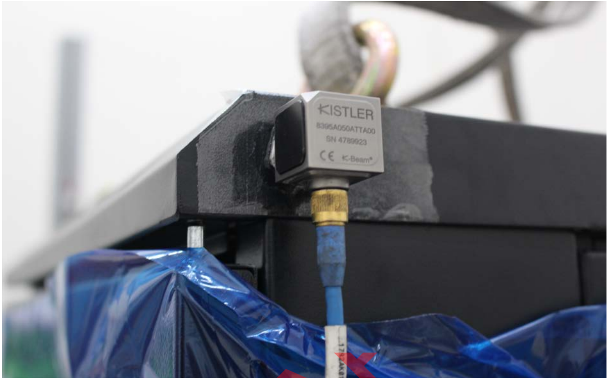
[그림 4-7] 가속도계 부착 - Rack 상단
