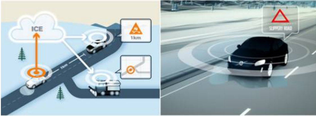
<그림 2-30> 스웨덴 및 노르웨이 노면 미끄럼 검지기술 개요도
