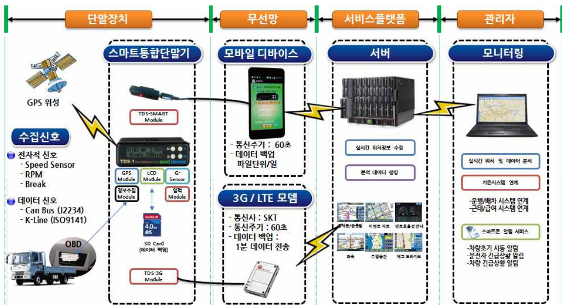
<그림 1-9> 기 운영 중인 물류솔루션 제공업체의 트럭관리시스템 구성도
