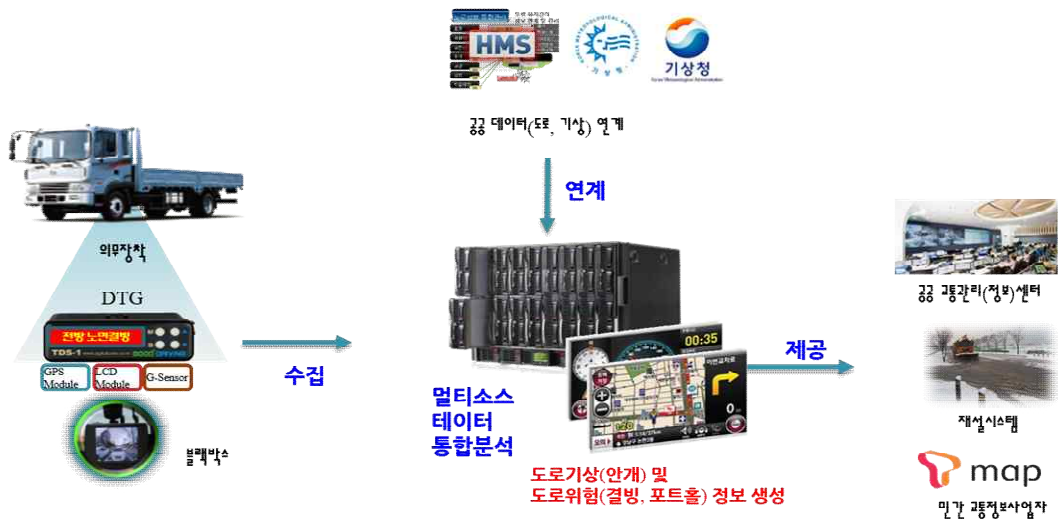
<그림 3-6> 트럭관리시스템 플랫폼을 활용한 개발기술 적용 예시도
