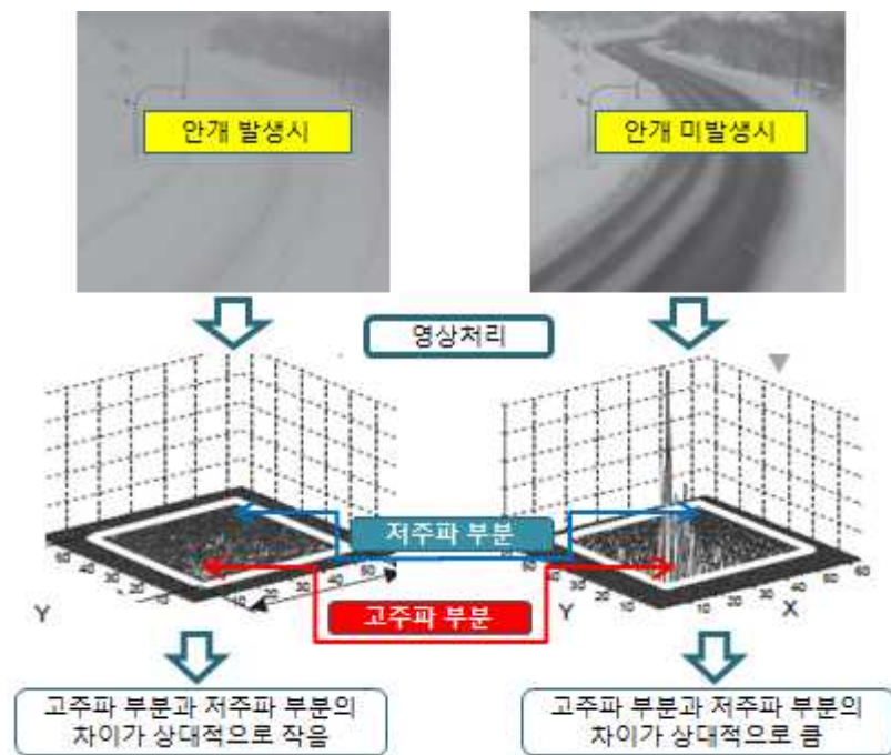
<그림 1-2> 사업용 차량 영상센서 기반 안개정보 수집기술
