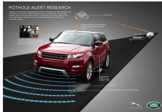
<그림 2-38> 랜드로버의 노면파손 탐지 및 경고 시스템
