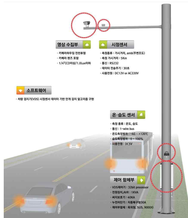
<그림 2-60> 차량 검지기(VDS)를 이용한 안개검지 기술
