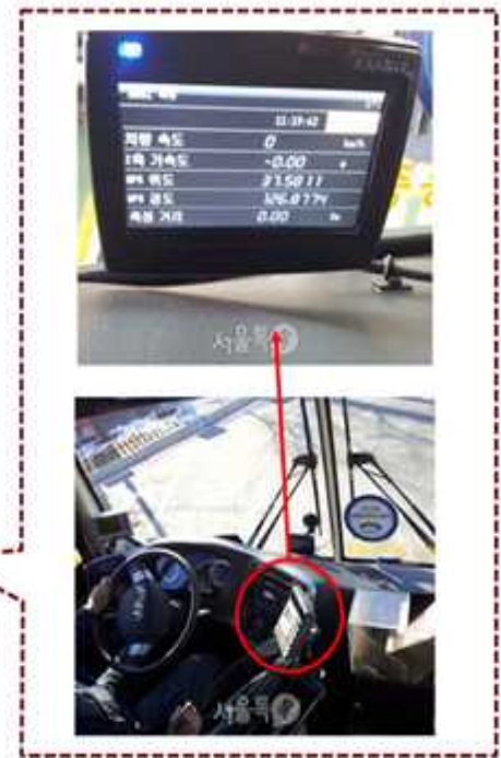
<그림 2-64> 버스의 진동센서를 이용한 노면파손 탐지
