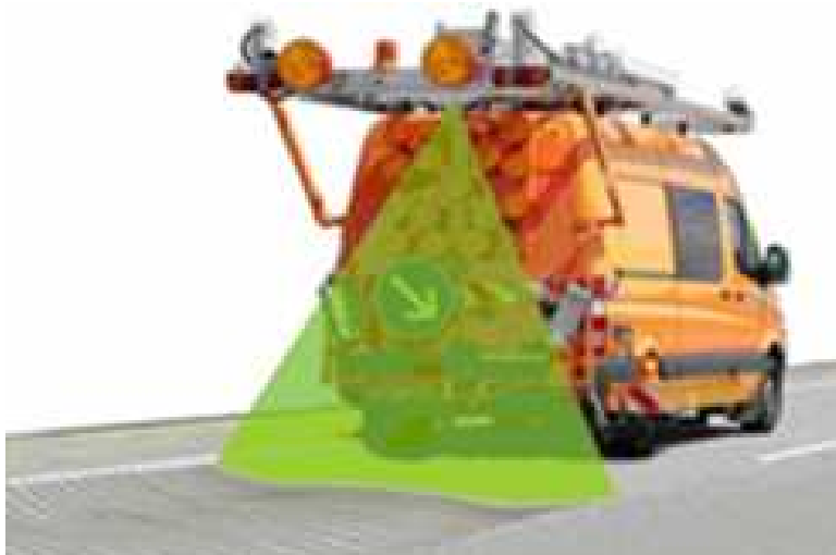
<그림 2-40> 3D 레이저 스캐닝을 통한 노면파손 탐지
