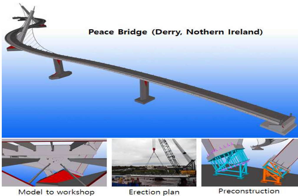
<그림4-18 디지털 모델 기반의 제작 및 사전시공의 예(Peace Bridge)>
