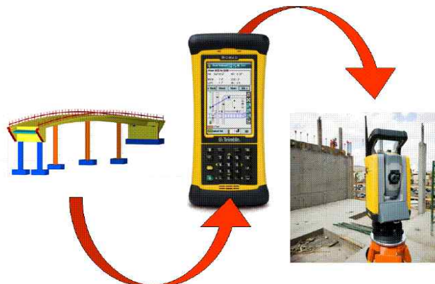
<그림 2-12 BIM 모델과 레이저스캐닝, GPS 장비와의 연동 개념도>
