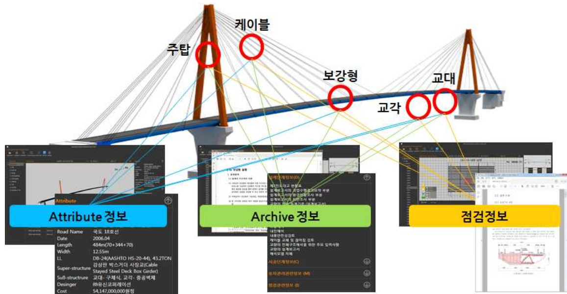
<그림 2-13 BIM 기반 특수교량의 유지관리정보체계>
