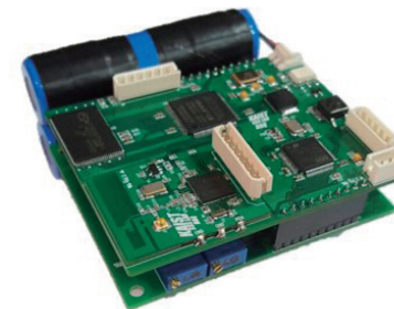
강재 피로균열 모니터링용 무선 센서노드 시제품
