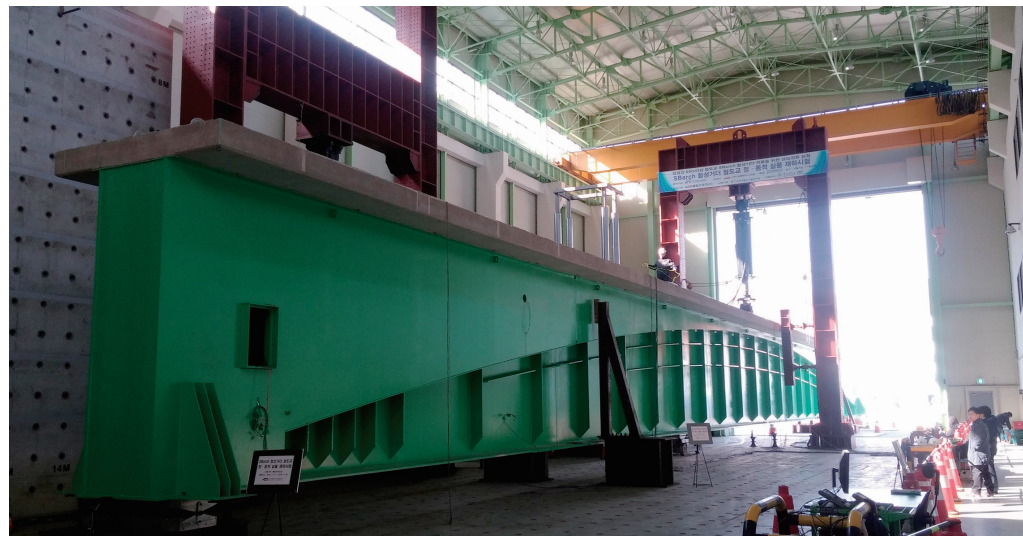
SBarch 합성거더 60m 철도교 실물실험(명지대 하이브리드 구조실험센터)
