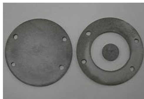
그림 40. 전자파 차폐 소재 평가 장치(좌) 및 제작 시편(우)
