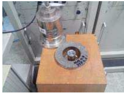
그림 36. 전자파 차폐 측정 장비 및 실험 결과(MF = 강섬유, 0.3/0.5 = 혼입률)
