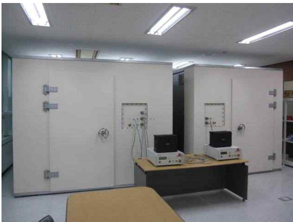
그림 41. 충격흡수구조를 적용한 발포알루미늄 방폭 및 EMP차폐 패널
