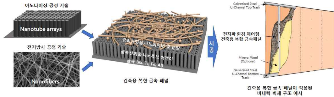
그림 162. 전자파 흡수 금속 패널 개발 개념도
