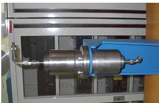
그림 40. 전자파 차폐 소재 평가 장치(좌) 및 제작 시편(우)
