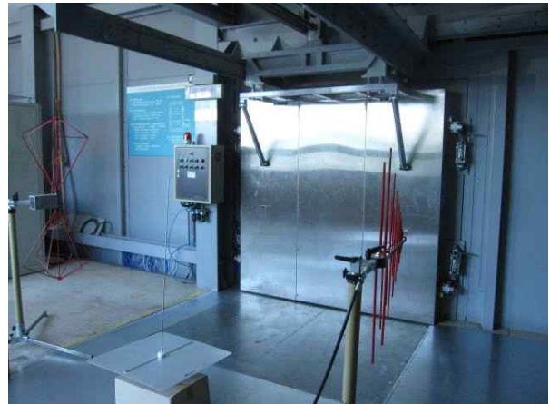
그림 41. 충격흡수구조를 적용한 발포알루미늄 방폭 및 EMP차폐 패널
