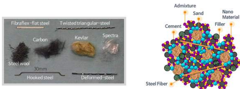
그림 10. 시멘트 복합재료 구성 및 섬유 종류
