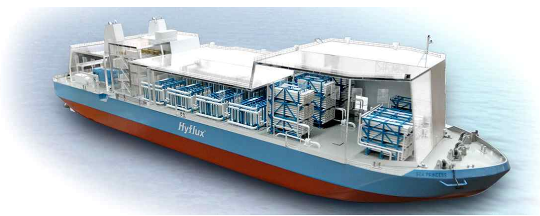
그림 52 선박탑재형 해수담수화 시설의 예 (출처: Hyflux)
