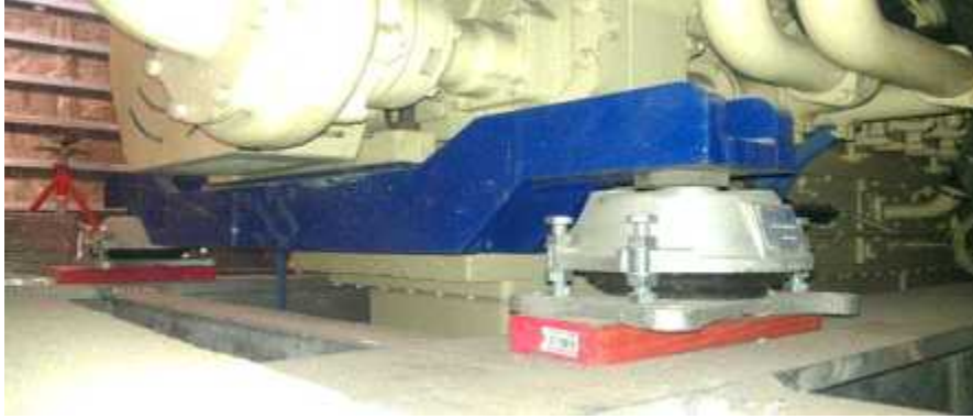
그림 97. 선체와 장비 사이에 진동을 절연시키기 위한 탄성마운트
