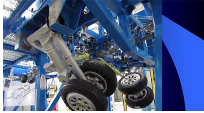
< Swing Test 설비 >
