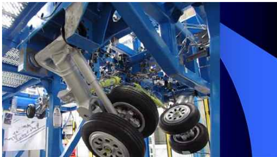
< Swing Test 설비 >
