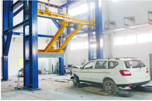
<그림 2-6> 진자(Pendulum)를 이용한 자동차의 저속 충돌 시험
