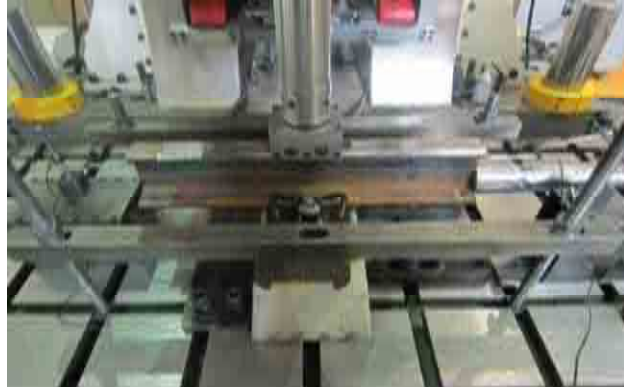
<궤도-교량 상호작용 해석제원 도출을 위한 체결구 종저항력 시험장면>
