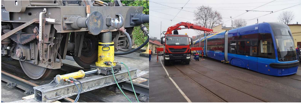
<그림 59> 화차 Rerailing 장비 예시 <그림 60> 저상트램 복구기술 예시
