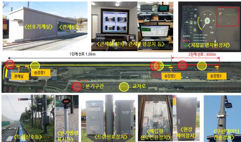
<그림 46> 무가선 저상트램 시험선 트램신호 설비 및 배치도
