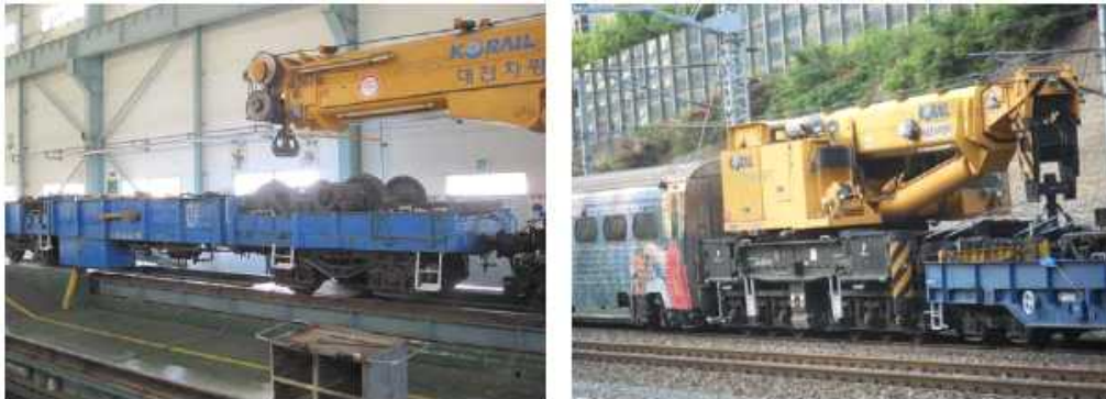
<그림 61> 사고복구용 기중기 보관 및 출동시 사진(국토교통진흥원 기획보고서 발췌)
