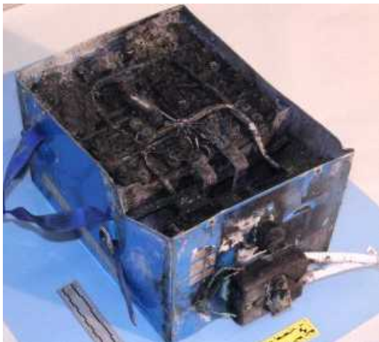
<그림 76> 폭발한 리튬 배터리 예시
