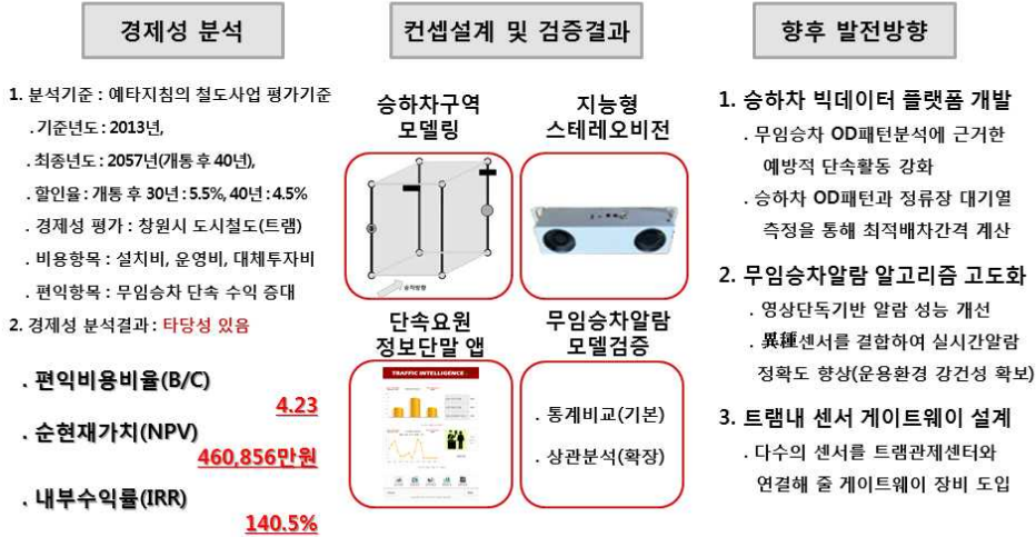
<그림 67> 트램 무임승차방지시스템(안) 및 효과분석
