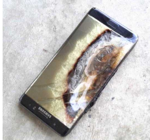
<그림 76> 폭발한 리튬 배터리 예시
