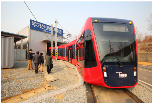
<그림 41> 무가선 트램 시험선에서 시험운행 중인 트램
