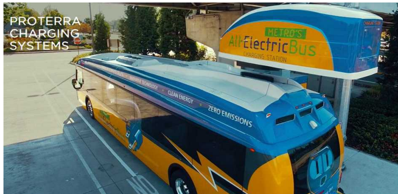
<그림 44> Proterra 社의 Overhead Fast Charger
