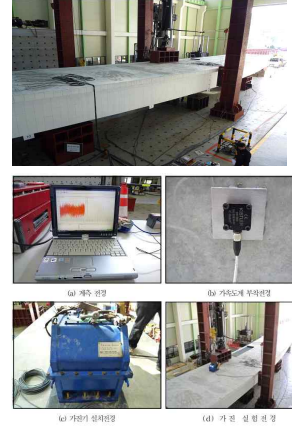
<곡선PSC 거더실험체의전경, 고유진동수측정장비 및 전경>
