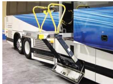
<그림 9> 라이콘사의 접이식(매립형) 휠체어 승강장치 (Mirage F9T)
