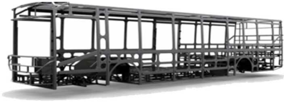
<그림 18> 현대 유니버스 차체 프레임 구조
