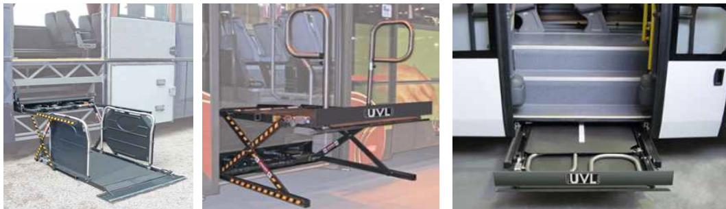
<그림 7> 브라운사의 접이식(계단형) 휠체어 승강장치(UVL시리즈)
