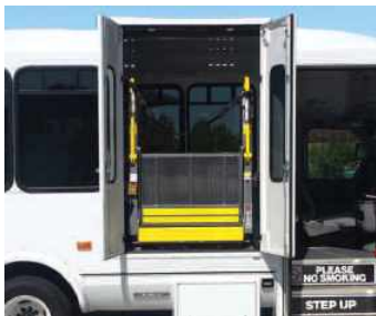
<그림 10> Ricon사의 접이식(노출형) 승강장치(K and S-series) 및 작동범위 제한 예시
