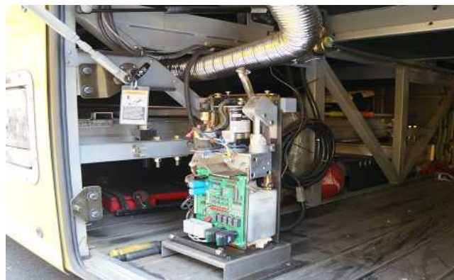
<그림 118> 접이식 매립형 승강장치 수화물 적재공간 설치
