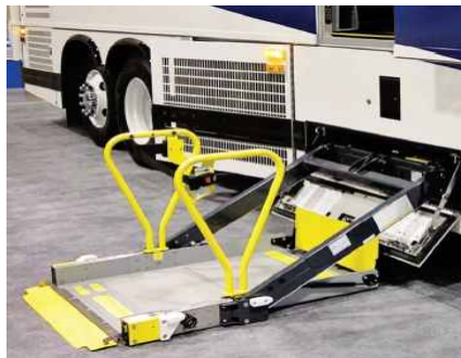
<그림 9> 라이콘사의 접이식(매립형) 휠체어 승강장치 (Mirage F9T)
