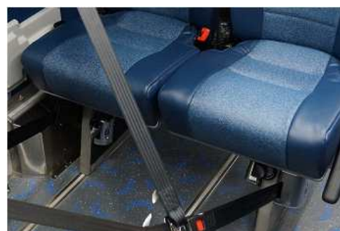
<그림 69> 휠체어 뒤쪽 고정장치 및 안전벨트
