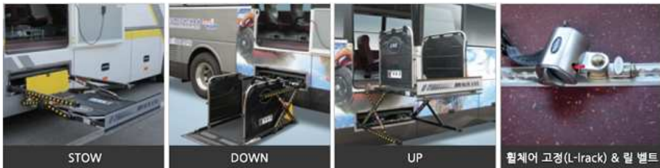
<그림 5> 매립형 휠체어 승강장치 국내 적용사례(출처 : 창림모아즈㈜)
