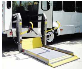
<그림 10> Ricon사의 접이식(노출형) 승강장치(K and S-series) 및 작동범위 제한 예시
