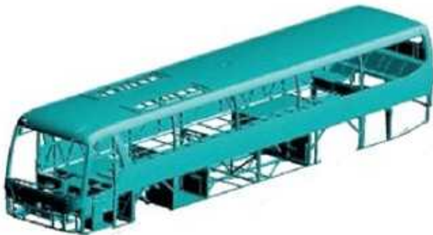
<그림 24> 자일대우 FX120 차체 프레임 구조
