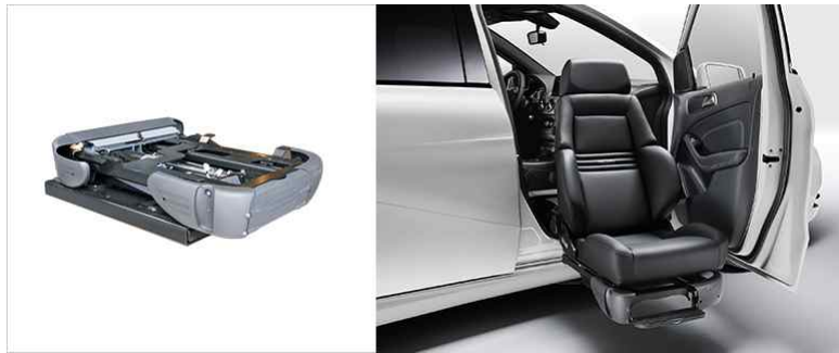
<그림 15> 회전형 탑승좌석(Swivel seat)
