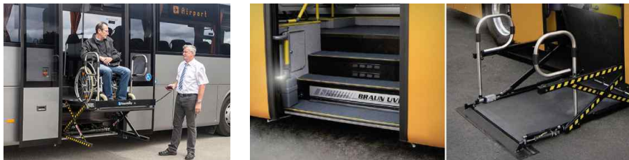
<그림 16> 브라운사의 휠체어 승강장치 모델
