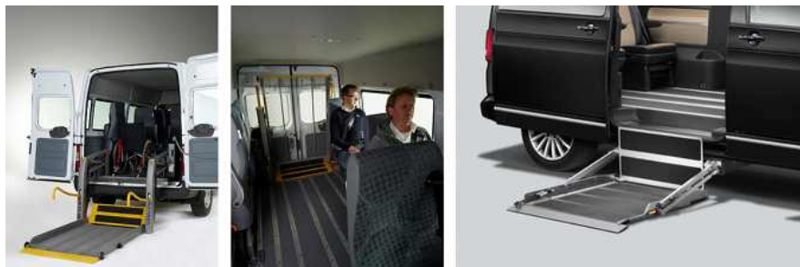
<그림 13> 노출형 및 매립형 휠체어 승강장치
