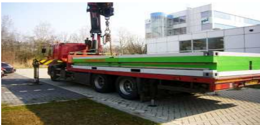
b. Cargoshell 사 컨테이너 접이 완료
