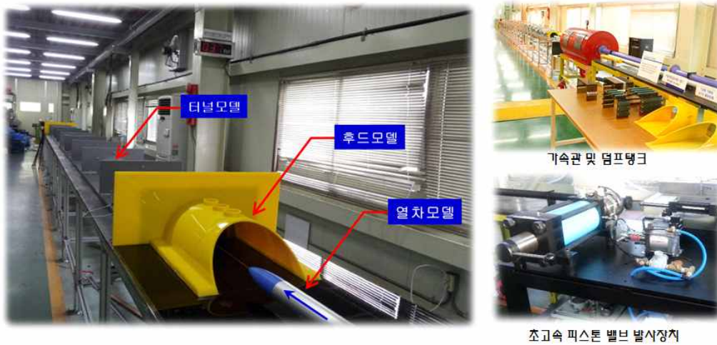
그림 2.4.6 한국철도기술연구원의 열차모델 주행시험기(최고속도 1,060km/h, 1:61 축척 시험기)
