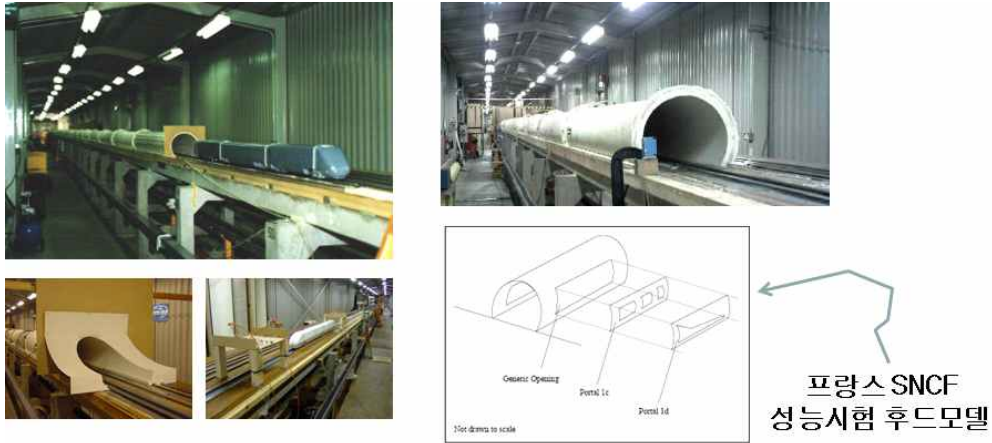
그림 2.4.2 영국 MU의 열차모델 주행시험기(최고속도 270km/h, 1:25 축척 시험기) : 프랑스 SNCF와 공동사용 시험설비
