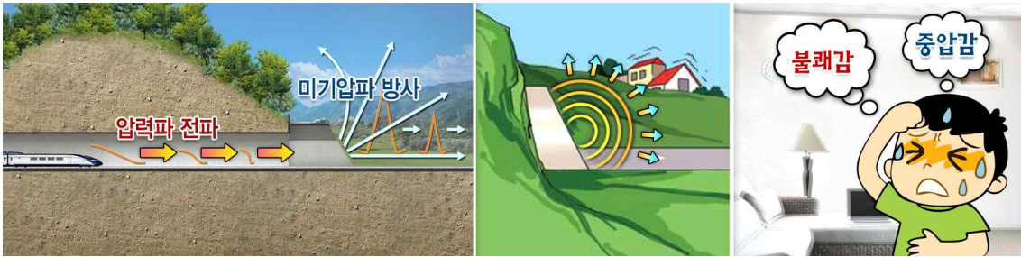
〈터널 출구에서의 미기압파 방사현상 및 민가의 환경피해(폭발음&진동)〉
