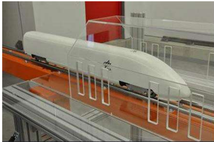
그림 2.3.16 독일 ICE3 노선을 위한 슬롯형 “터널 미기압과 저감 후드 “ (독일 DLR)
