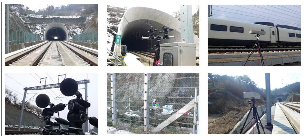
그림 2.3.46 터널 미기압과 측정 전경(회룡터널 출구 20m에서의 미기압과 측정)
