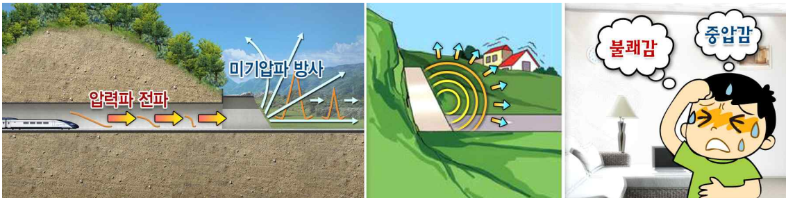
그림 1.2.1 터널 출구에서의 미기압파 방사현상 및 민가의 환경피해(폭발음&진동)
