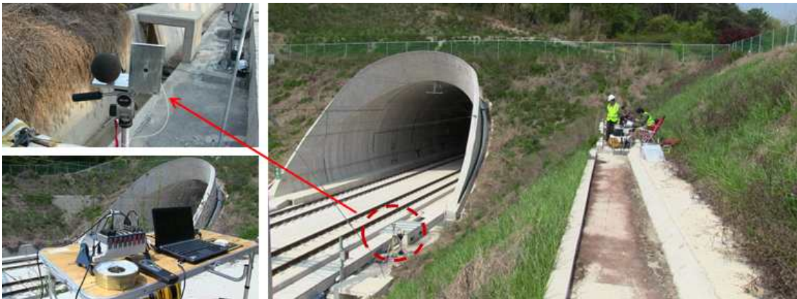
그림 2.3.6 터널 미기압파 현장시험 사례(호남고속철도 회룡터널)
