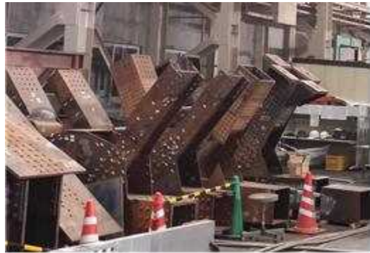
그림 2-68. Truss교량 이음부 상세 실험
