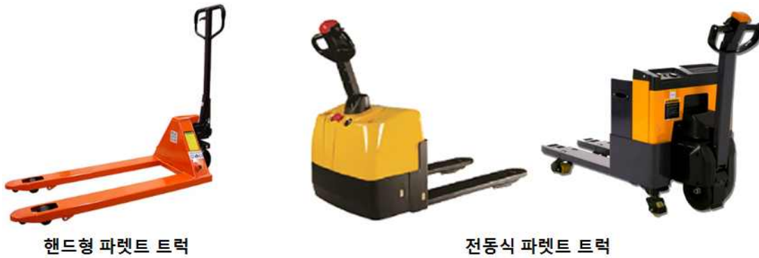
<그림 2-53> 파렛트 트럭 종류 및 구조
