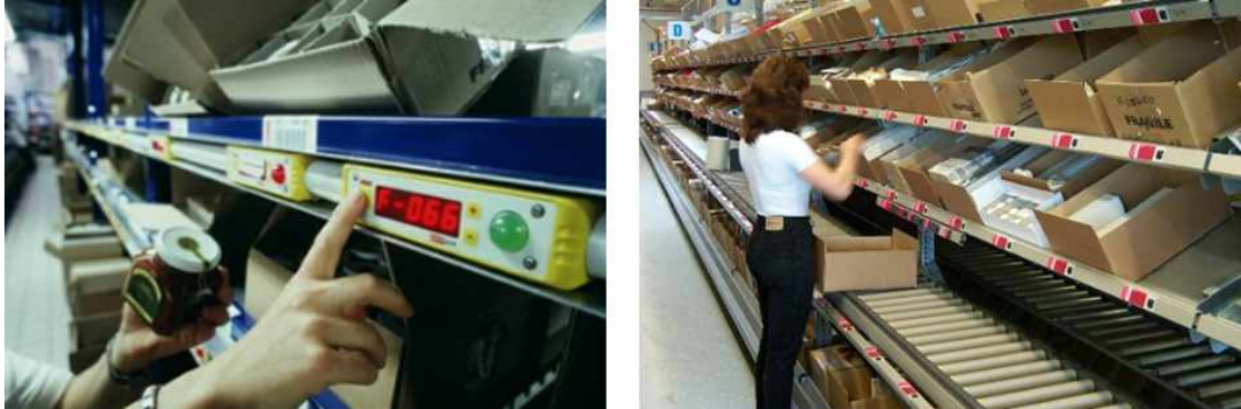
<그림 2-19> Pick by Light 방식을 이용한 피킹
