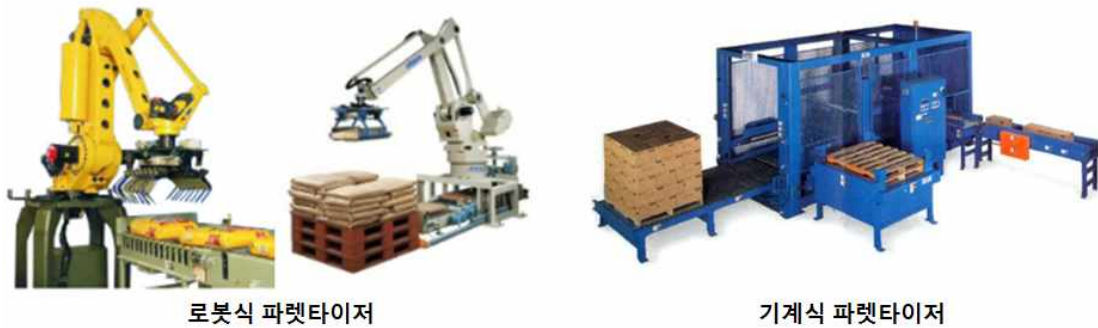
<그림 2-54> 파렛타이저 종류 및 구조
