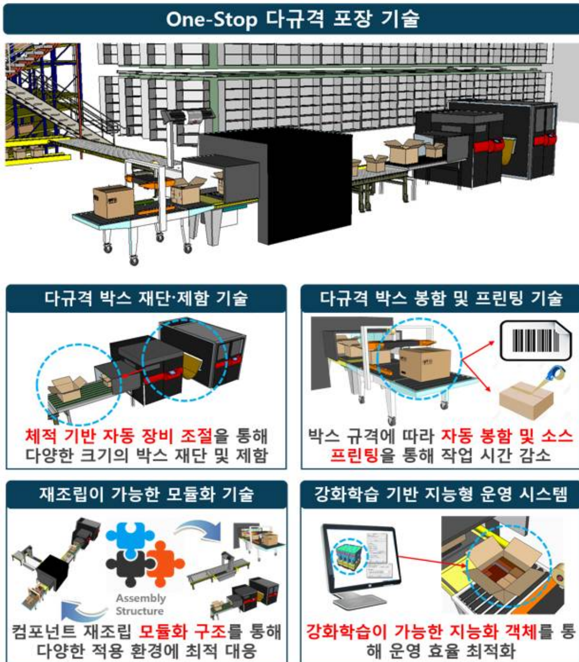
<그림 3-12> One-Stop 다규격 포장 기술 개요
