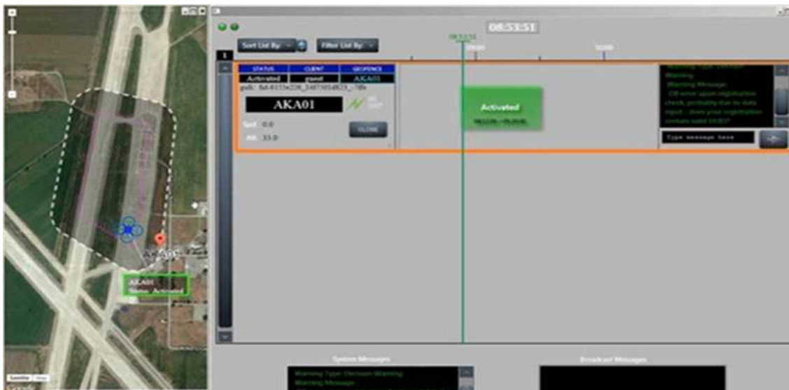
그림 2-10. NASA UTM TCL1에 사용된 시스템계획 및 추적 디스플레이 (좌측 화면은 운용영역, 핑크실선은 비행 계획, 점선은 비행 가능 영역을 표시, 우측 화면은 승인된 비행 계획과 다수 무인기의 운용 상태를 표시하며, 이 영역을 이용하여 UTM 관리자가 무인기 운용자에게 메시지 송신 가능)
