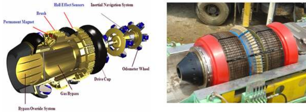
그림 2.4.7 부산대학교의 자기누설비파괴 검사 시스템
