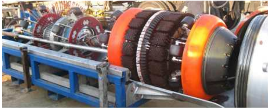
▣ 그림 2.4.20 Baker Hughes GEMINI™ high-resolution MFL and caliper ILI tool ▣
