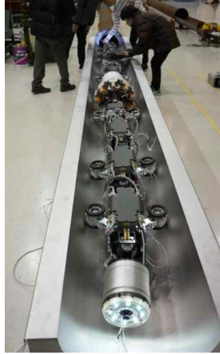
■ 그림 2.4.1 한국가스공사 연구개발원의 연피거블 자가추진형 비파괴 탐상 장비 ■
