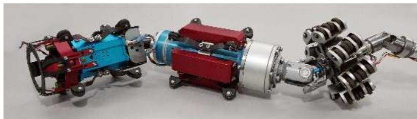
■ 그림 2.4.2 한국원자력연구원의 화력발전소 배관 비파괴 탐상 장비 ■
