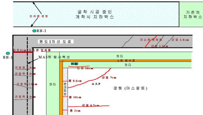
<그림 1.14> 00현장 개착공사로 인한 지반변형 예
