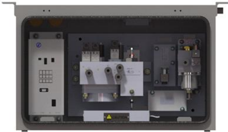
그림 18 ITX-새마을 전동차 BOU 형상(모델명 : YB34) ※ YB34 BOU사이즈: 800mm x 523mm x 460mm, 중량 : 약 75kg (보안제동 관련계통 포함)
