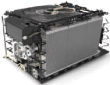
그림 180 Front-end cooling system
