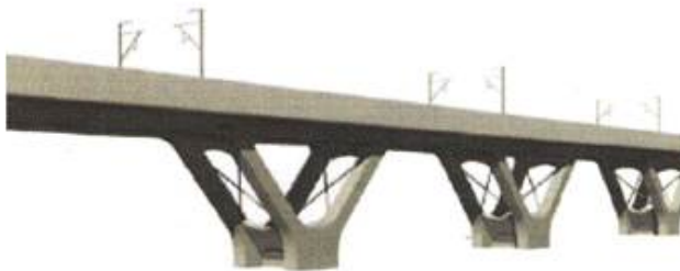
그림 2.40 Jose, Herve, Battice, Ruyff Bridge-2중 박스거더교(Belgium)
