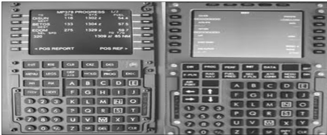
<그림 4-10> 비행관리 컴퓨터(좌: A320 FMGS, B737:FMC)
