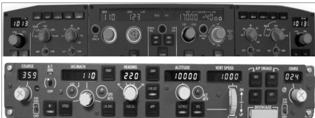
<그림 4-11> 항공기의 FCU와 MCP(상: A320 FCU, B737 MCP)
