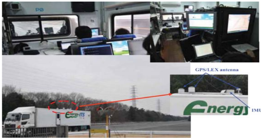
[그림 20] 차로구분 수준 위치결정 연구를 위한 차량 및 GPS 탑재장비
