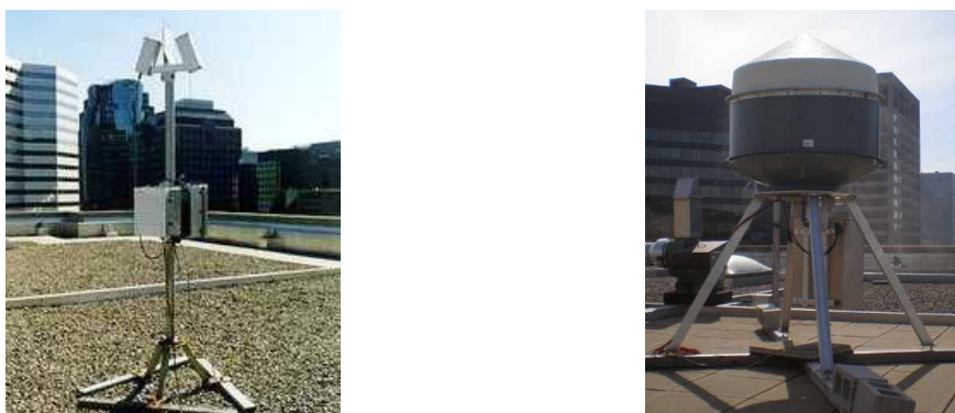
그림 9. 강우발생 감지 시스템-POSS(McGill, 2014), 연직 포인트 레이더-VPR(McGill, 2014)
