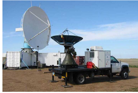
그림 16. S밴드 비슬산관측소(이중편파)(좌), X밴드 이동형 관측소(이중편파)(우)
