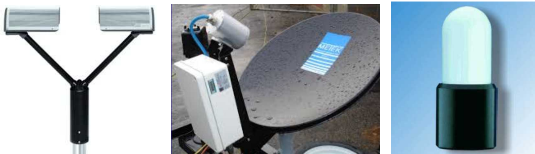
그림 8. 광학우적계-PARSIVEL(좌), 연직강우레이더-MRR(중), 레이더 강우센서(RRS)
