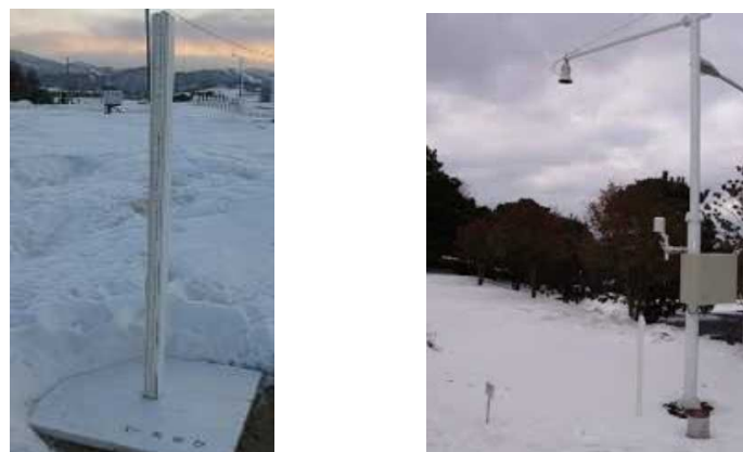
그림 11. 적설판(좌)과 자동 강설관측 장비(우)
