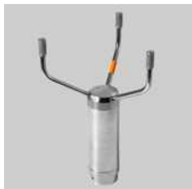
그림 14. 바람개비형 풍향풍속계(좌)와 3차원 초음파 풍향풍속계(Vaisala, 2014)
