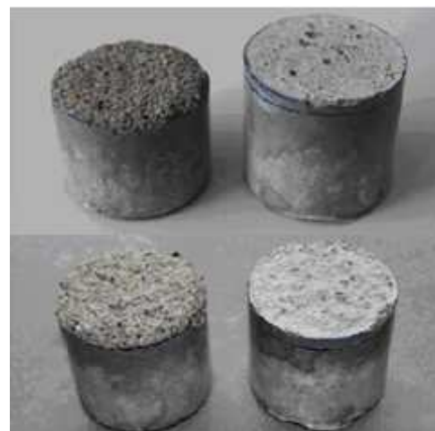
(b) 특수첨가제를 적용Na-MFP 용액을 이용한 scaling 감소
