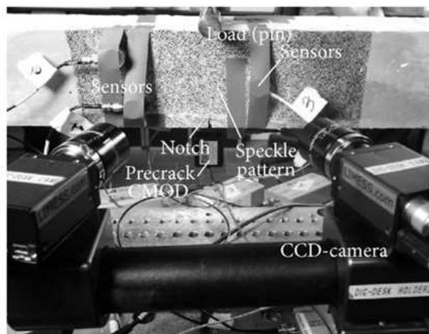
[그림 2-37] Acoustic Emission을 통한 자기치유 성능 평가 방법 (Tsangouri et al. , 2013)
