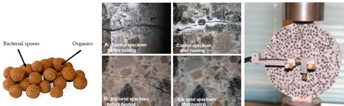
[그림 2-21] 미세물을 이용한 균열 자기치유 사례 (Jonkers, 2011)
