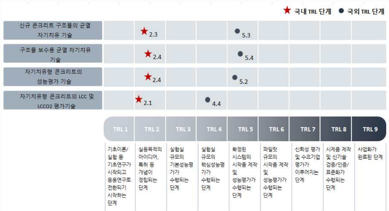
[그림 3-37] 자기치유형 콘크리트 적용기술분야 기술성숙도
