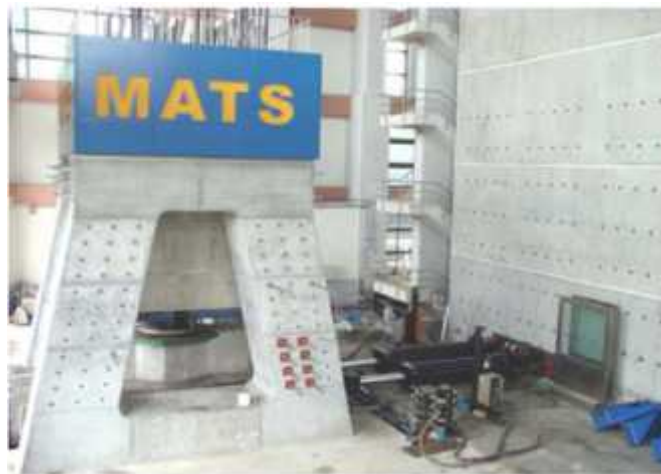
[그림 1-1] 대만 NCREE의 일체형 UTM (MATS: Multi Axis Testing System)
