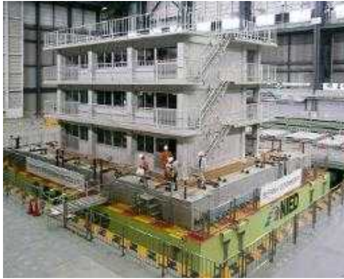
(b) 면진장치 성능평가를 위한 4층 규모의 철근콘크리트 구조에 대한 내진성능 평가
