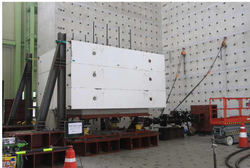
[그림 1-10] 원자력발전소의 내진설계에 사용되는 면진장치 실험
