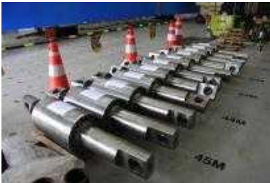
[그림 1-14] 2,500kN STU 실험체
