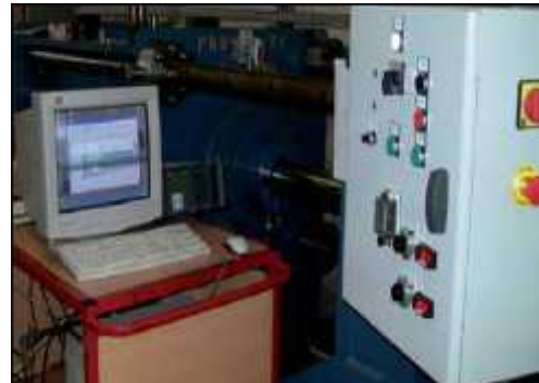
[그림 1-30] 점성댐퍼 성능시험 장비
