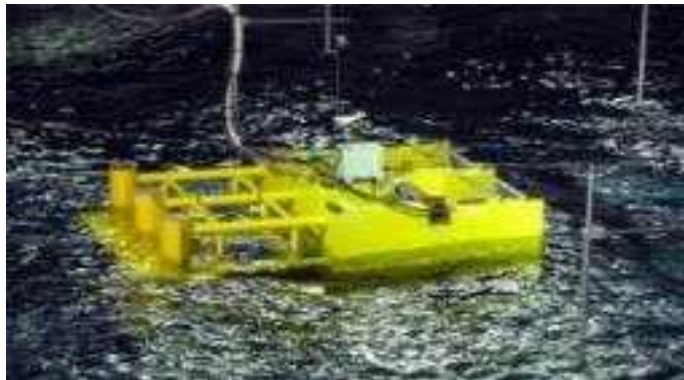
[그림 3-4] 300kW 부유식 진자형 파력발전장치 수리모형실험 수행 장면
