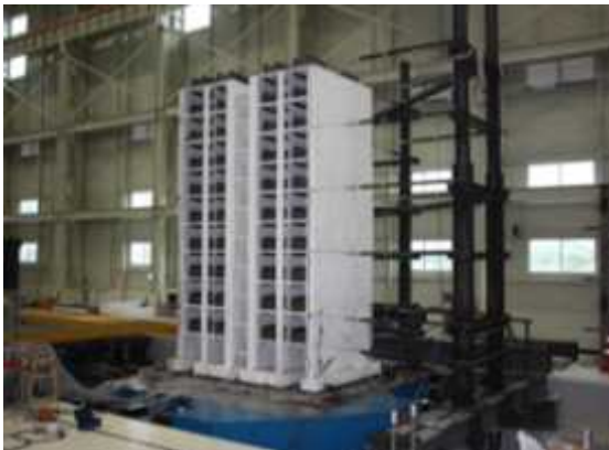
[그림 8-19] scale 내력벽식 구조물의 지진실험
