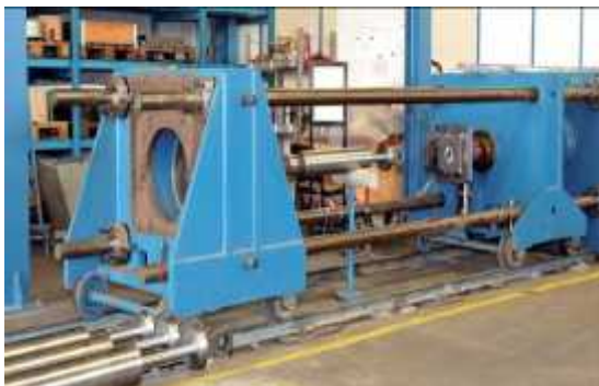
[그림 1-30] 점성댐퍼 성능시험 장비
