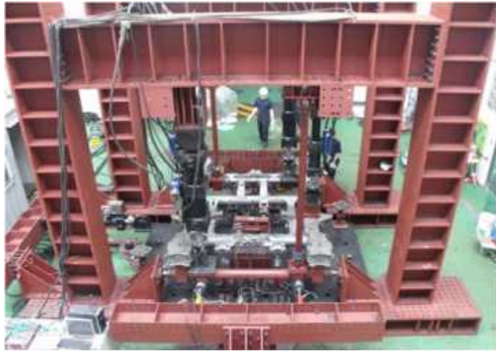
[그림 7-20] 철도차량 Bogie Frame 6자유도 실험
