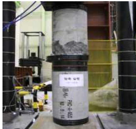
[그림 1-22] 고성능 강재 인장강도 및 콘크리트 압축강도 실험
