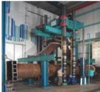
[그림 1-31] 대용량 UTM을 이용한 원형 구조물 성능 실험
