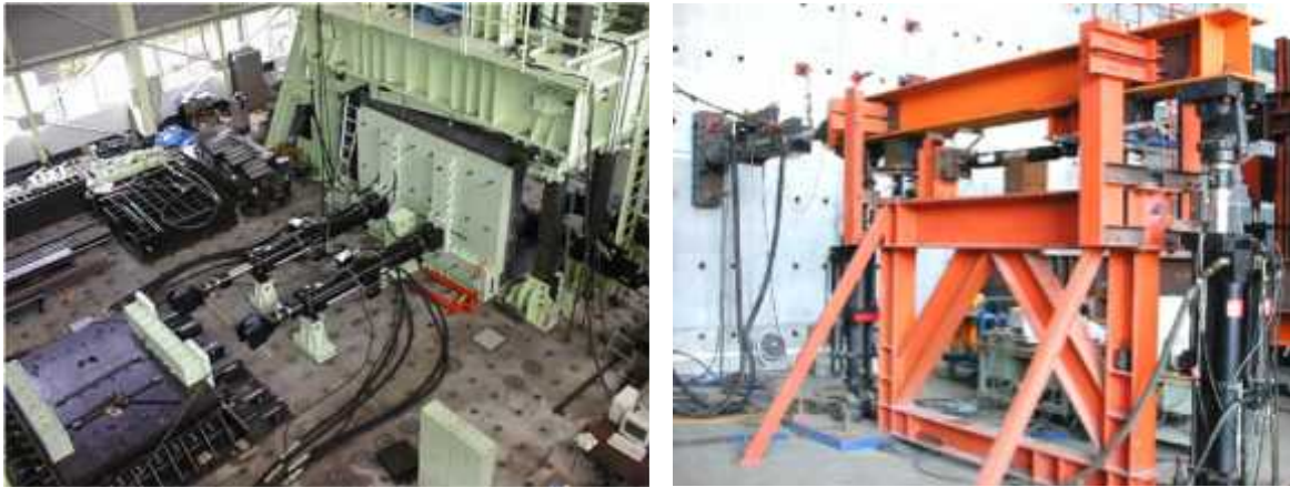
[그림 7-29] 고성능 Actuator를 조합하여 구성한 진동대 실험 시스템
