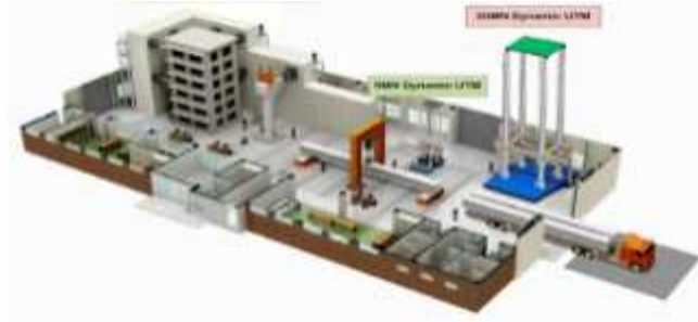
[그림 1-48] 20MN급 일체형 UTM 설치 위치도
