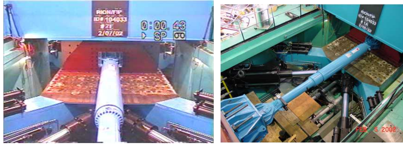
[그림 1-11] RION-ANTIRION BRIDGE GREECE FIP Damper Test
