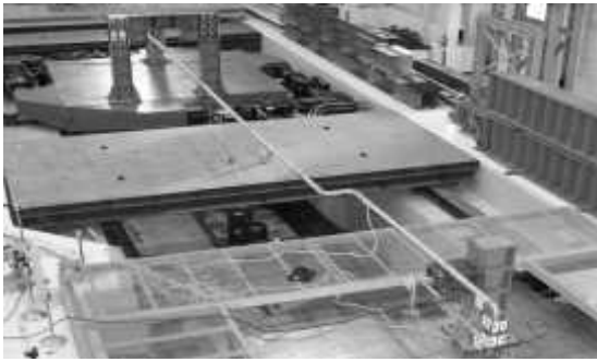
[그림 8-30] 배관계통의 설치 모습과 응답스펙트럼
