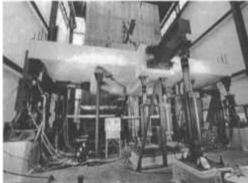
[그림 7-25] 교량 및 건물의 다양한 하중 모사용 시뮬레이터
