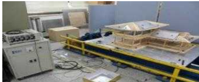
[그림 8-31] 진동대 전경 및 축소 모형 실험체 모습
