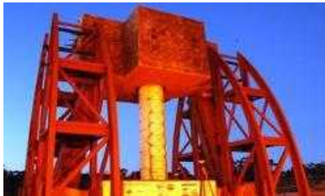
[그림 8-38] UCSD의 LHPOST를 이용한 실규모 기둥의 내진성능평가
