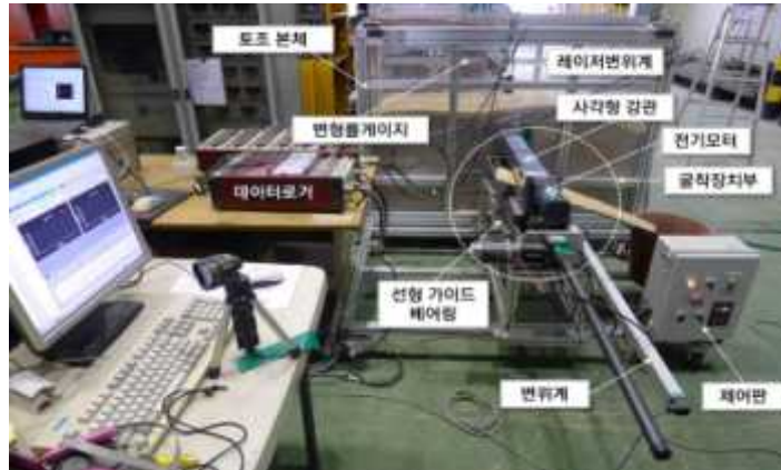
[그림 5-5] 모형 토조 실험장비의 주요 구성
