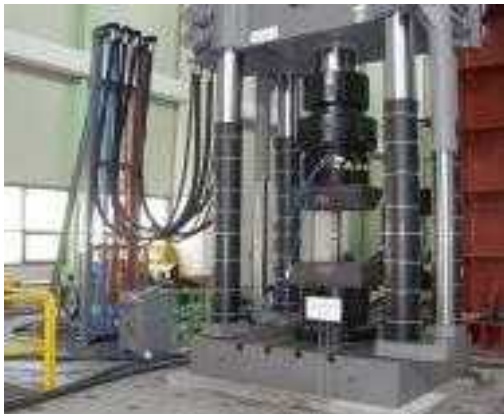
[그림 1-22] 고성능 강재 인장강도 및 콘크리트 압축강도 실험
