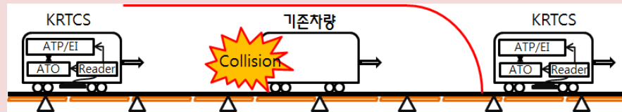
궤도회로 기반의 열차를 인식하지 못한 열차추돌 상황
