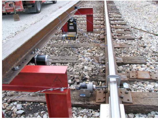
그림 2.4-36. 진동을 이용한 중립온도 측정
