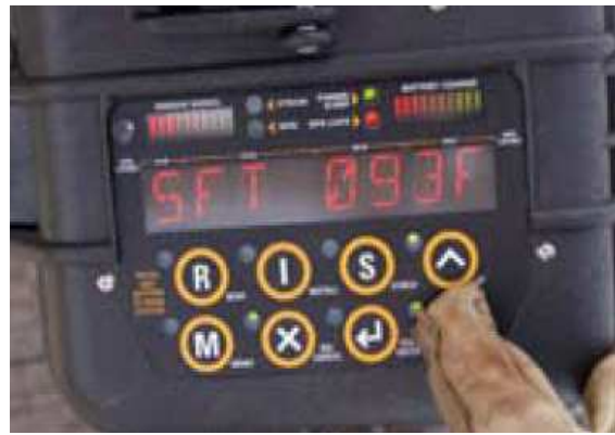
그림 2.4-33. SFTPRO를 이용한 응력, 레일온도, 중립온도 측정
