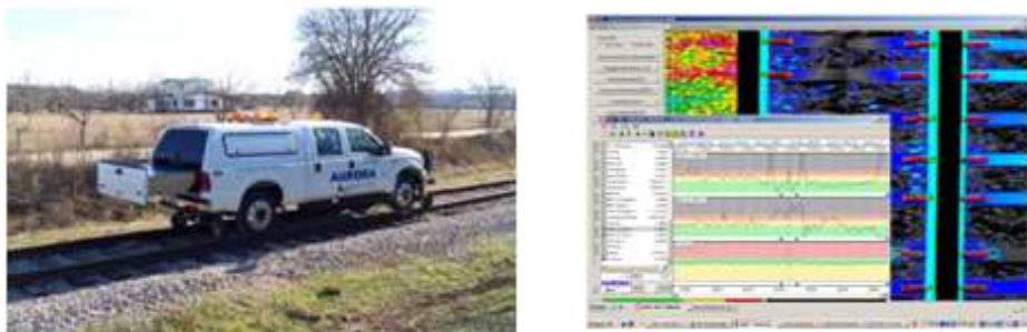
그림 2.4-63. 스캐닝 기술을 이용한 궤도 상태 평가
