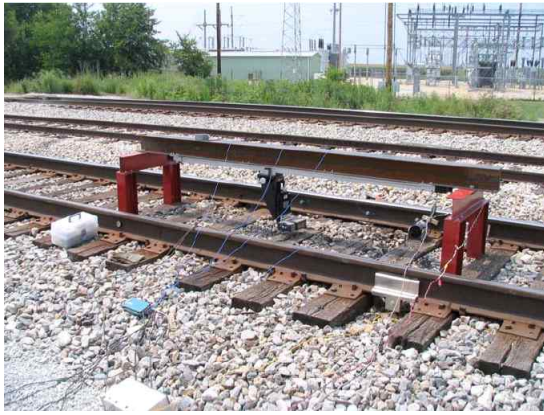
그림 2.4-36. 진동을 이용한 중립온도 측정
