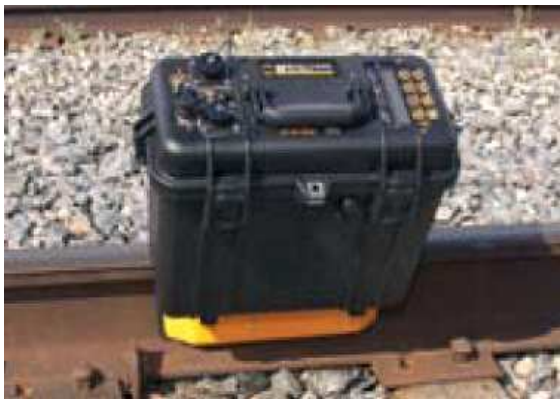
그림 2.4-33. SFTPRO를 이용한 응력, 레일온도, 중립온도 측정
