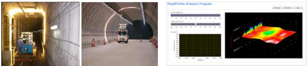
그림 2.4-28. 스캐닝 기술을 이용한 터널/도로 프로파일 측정
