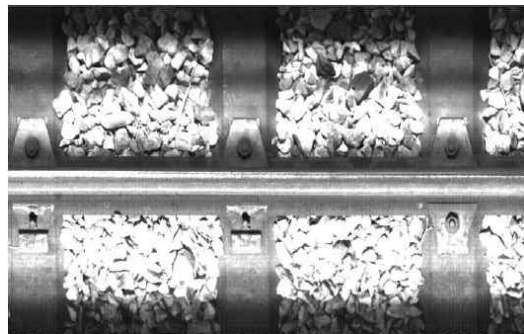
그림 2.4-29. 스캐닝 기술을 이용한 침목 결함 평가
