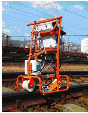
그림 2.4-34. RailScan을 이용한 중립온도 측정
