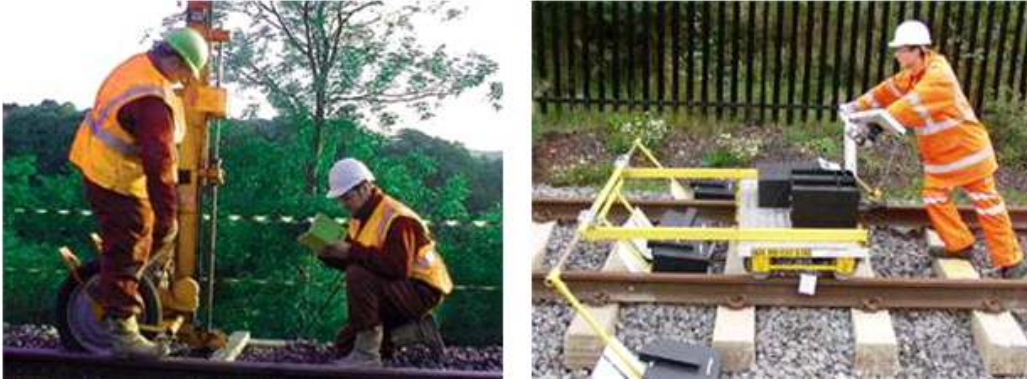
그림 2.4-11. 도상자갈 시추(영국) 및 GPR 탐사 장면(네덜란드)
