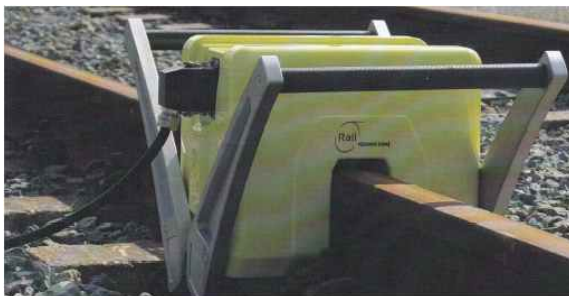
그림 2.4-37. Rail Stress Test를 이용한 중립온도 측정
