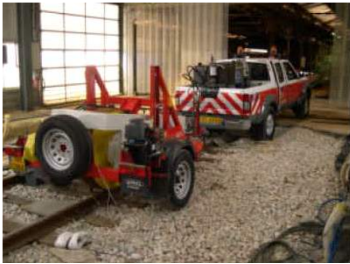
그림 2.4-54. Potancemeter를 이용한 궤도강성 측정개념
