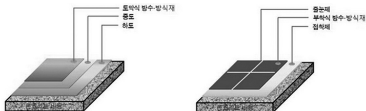
그림 49 고도정수처리시설의 내오존 방수방식시스템 시공단계별 시공방법
