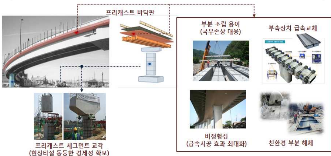
[그림 1.3] 부분 조립 및 교체가 가능한 지능형 급속시공 기술
