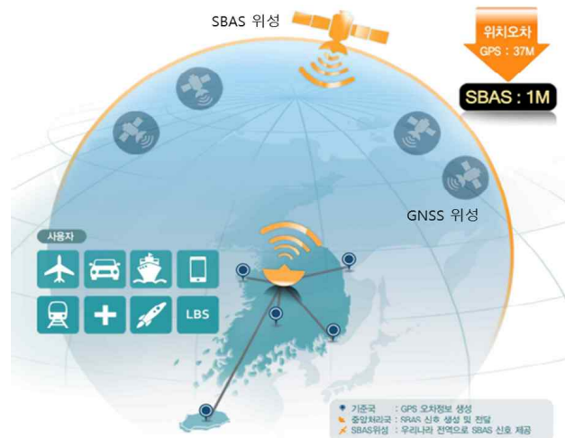
<그림 2-32> 한국형 위성항법광역보강시스템 (출처: 국토교통부)
