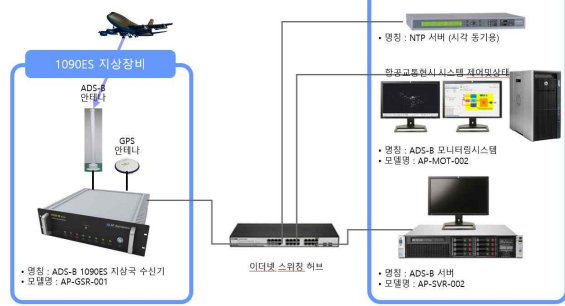
<그림 3-13> ADS-B 작동원리 및 구성도
