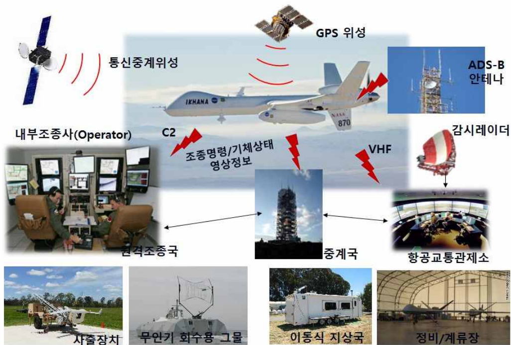
<그림 1-5> RPAS 운용개념도 (핵심요소 및 부가장비)
