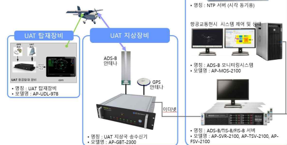
<그림 3-13> ADS-B 작동원리 및 구성도
