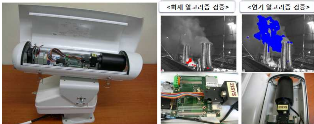
그림 73. 철도터널용 영상화재감지 IP 카메라 [(주)투아이시스, 2011]
