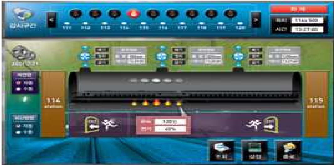
그림 72. 철도터널용 지능형 배연시스템용 제어기 [(주)리트코, 2010]
