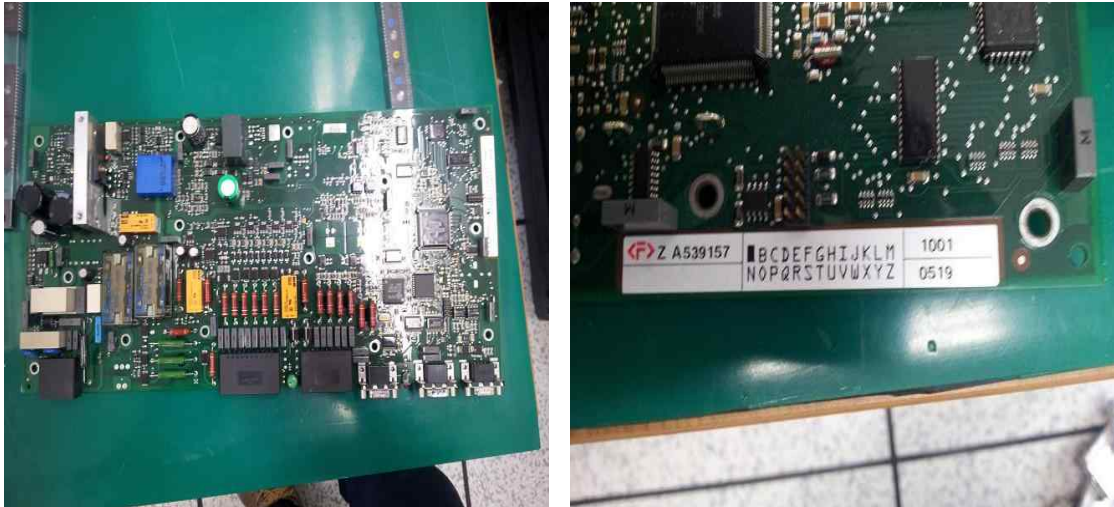
<그림2-60> 코레일공항철도 차량의 PCB Serial No 관리
