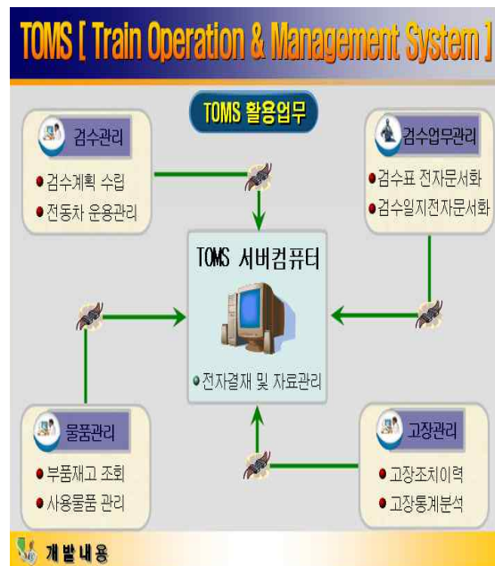
<그림2-30> 부산교통공사 전동차운용관리시스템 구성 및 활용 업무
