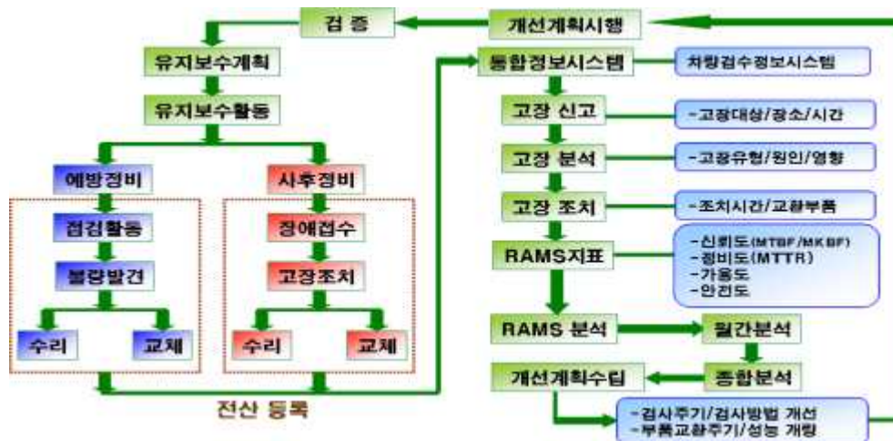
<그림2-57> 코레일공항철도의 RCM적용 차량 유지보수 절차도
