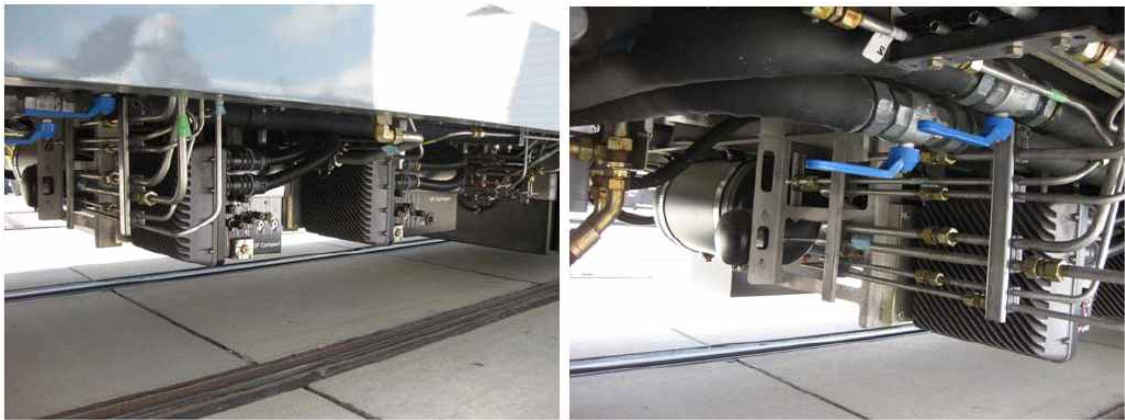
그림 24 해외 차량의 공기제동 모듈의 적용 예
