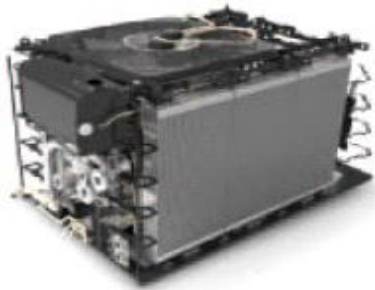
그림 195 Front-end cooling system
