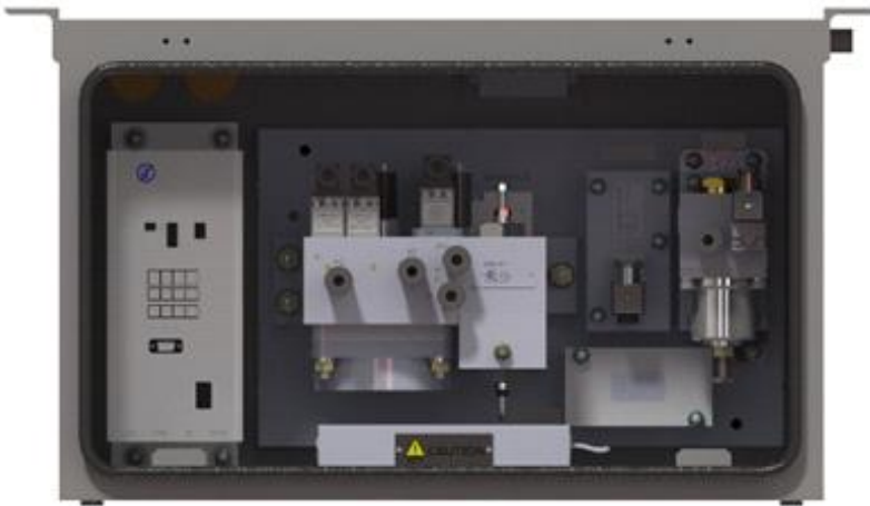
그림 19 ITX-새마을 전동차 BOU 형상(모델명 : YB34) ※ YB34 BOU사이즈: 800mm x 523mm x 460mm, 중량 : 약 75kg (보안제동 관련계통 포함)
