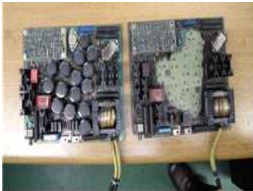
그림 55. VVVF 제어보드(정비 전/후)
