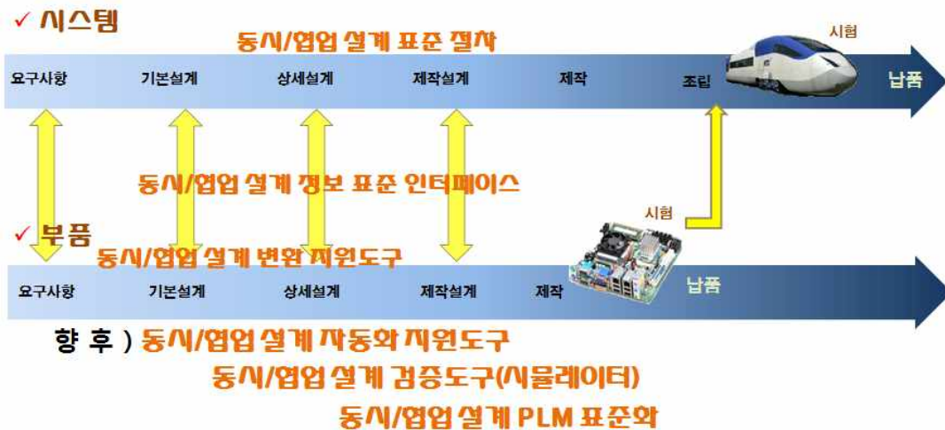
그림 219 철도차량 협업/동시 설계 요소 및 라이프사이클
