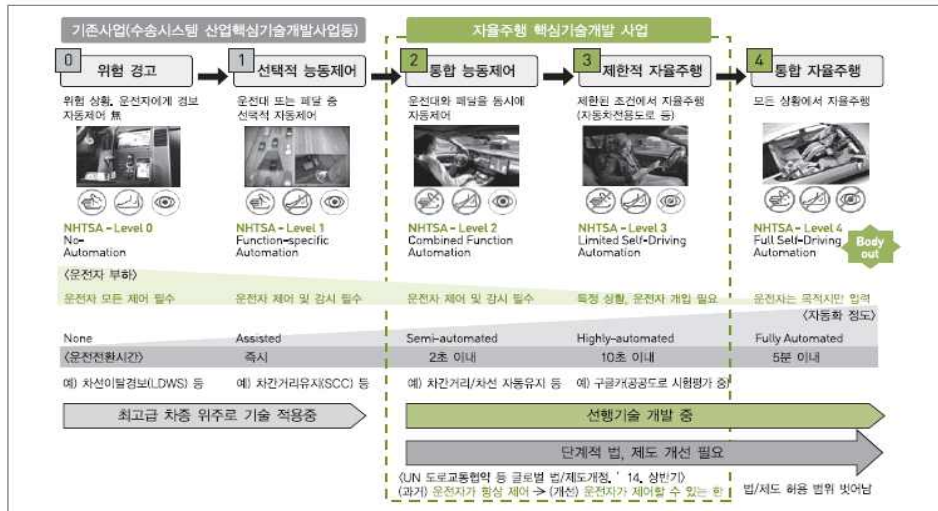
〈그림 2-6〉 자율주행 자동차의 가이드라인(NHTSA)과 자동차의 기술개발 범위 NHTSA : 미국 도로교통안전국(National Highway Traffic Safety Administration)
