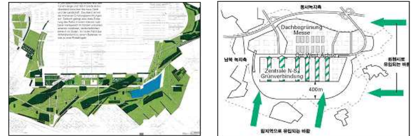
그림 2-81. 림의 오픈스페이스 구성(좌)과 바람길 형성을 위한 단지배치(우)
