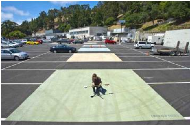
그림 2-47. 알베도 측정장치를 이용한 차열성 포장도로 코팅 측정
