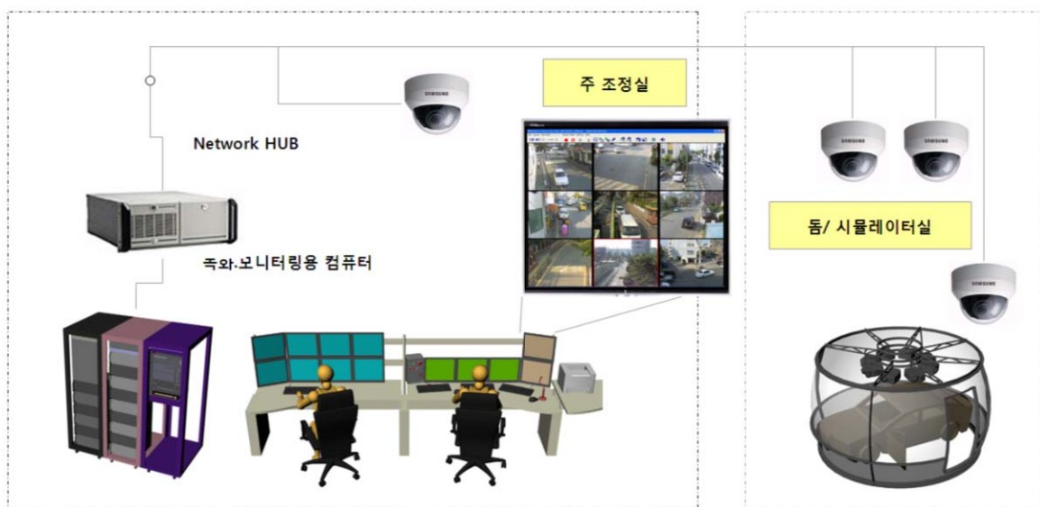
[그림 3-116] CCD 카메라 구성도
