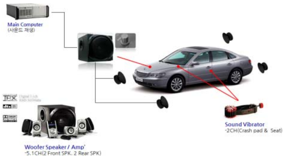
[그림 3-104] 음향 및 진동 장치 구성도
