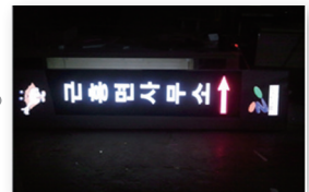
⑥ 조립된 도광판 수용홀에 조립작업 후 전원 및 조도 시험
