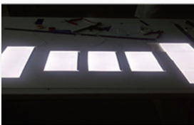
④ 도광판 수용홀에 도광판 조립 및 배선작업 및 전원 및 조도 테스트
