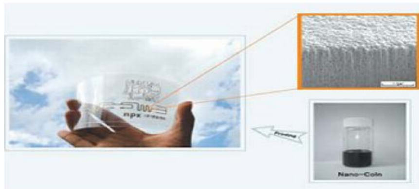
<그림 3.24. 은나노 잉크와 이를 이용한 RFID 소자>
