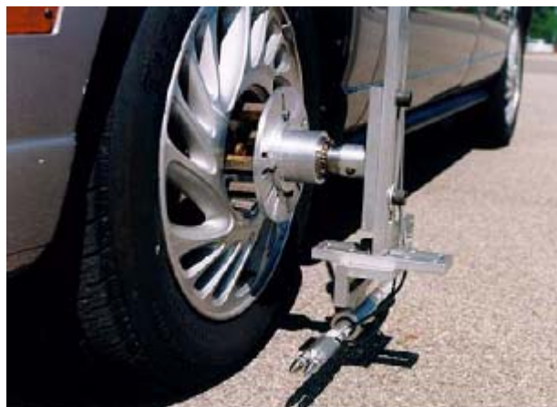
그림 4-33 음의 세기 측정용 탐침기의 탑재 모습
