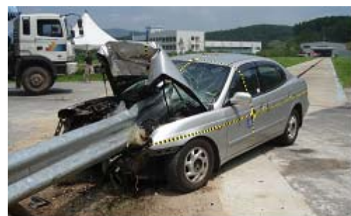
단부장치부재로 인한 충돌 (Simulated Test, 한국도로공사)
