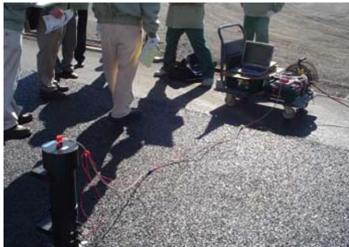
그림 4-34 임피던스 튜브를 이용한 포장 흡음율 측정
