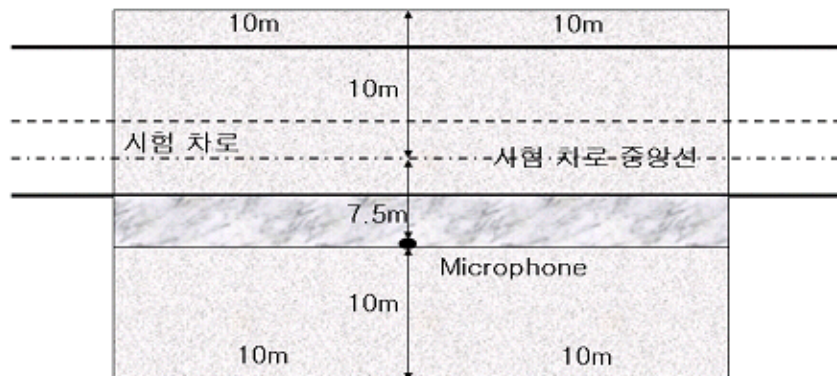
그림 4-22 SPB 소음 측정 조건-1 (ISO 11819-1, 1997)
