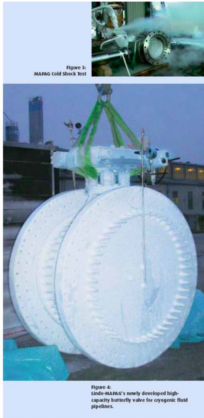
그림 2.18 초저온 재료 및 기자재 시험
