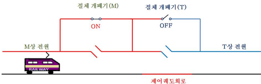
< 그림 2-2 절연구분개소 열차 진입 시 개폐장치 상태 >
